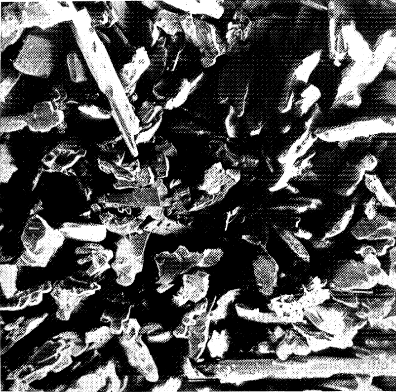
PHOTOGRAPHIE n° III.5 oxyde de molybdène 20\mu\text{m} < \phi_{\text{MoO}_3} < 36\mu\text{m} (x 350)
