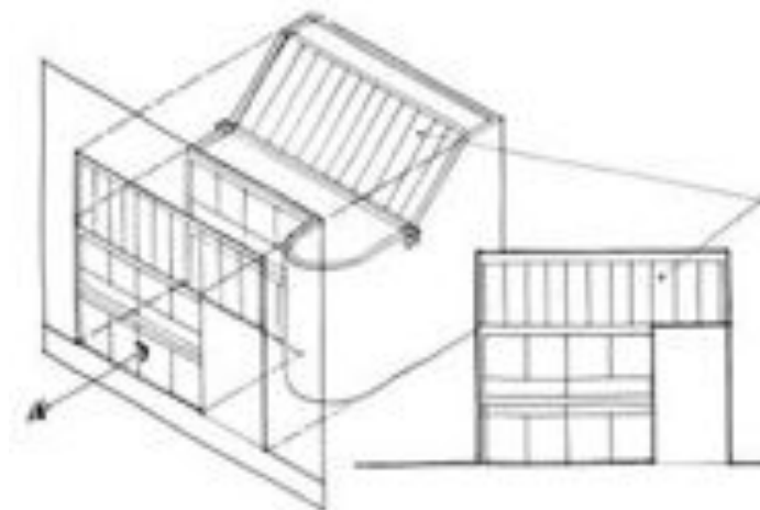
Figure 1.7 Élévation – tiré de Ching (1985 : 48)
