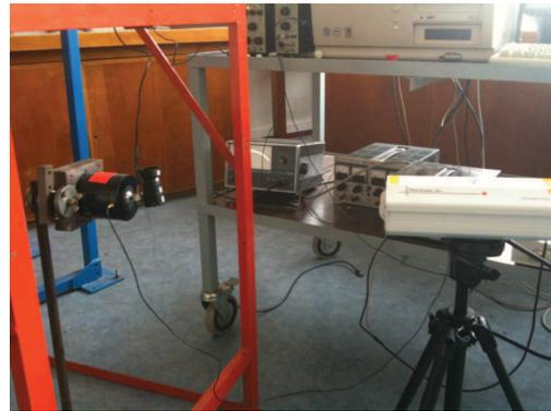
FIGURE 4.2 – Photo du dispositif pour l'analyse modale expérimentale
