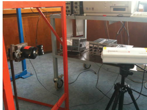
FIGURE 4.2 – Photo du dispositif pour l'analyse modale expérimentale
