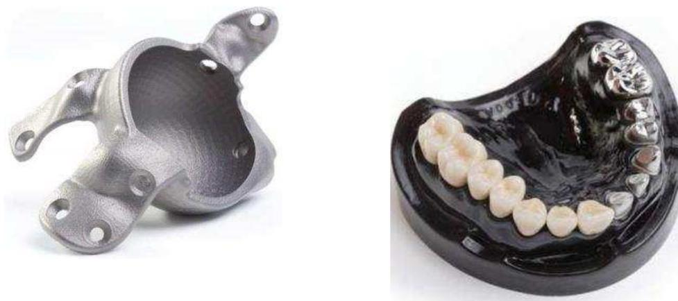
Figure I.14 Quelques pièces élaborées par SLM [28]
