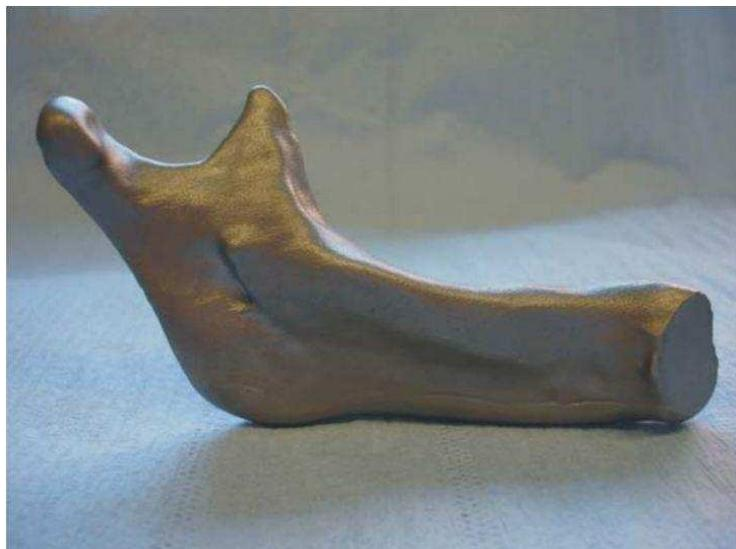
Figure I.26 Modèle physique 3D construit en TA6V [41]
