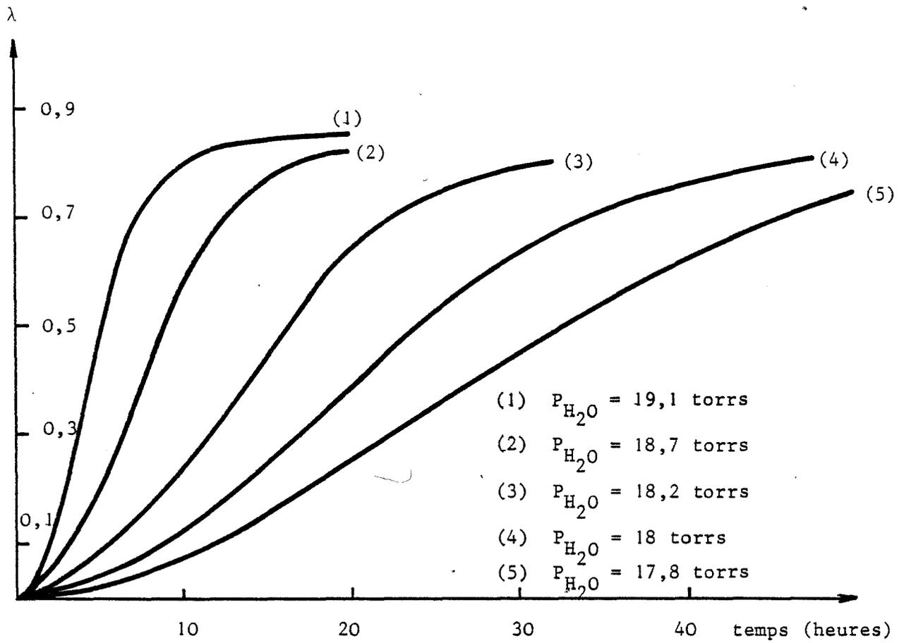
Figure 26 - Hydratation du sulfate de calcium hémihydraté - T = 22°C
