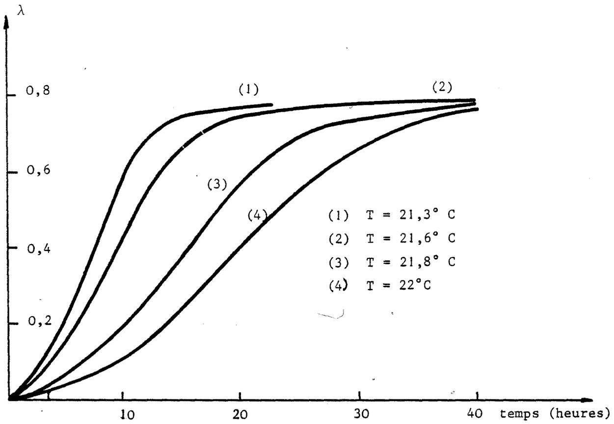
Figure 25 - Hydratation du sulfate de calcium hémihydraté
