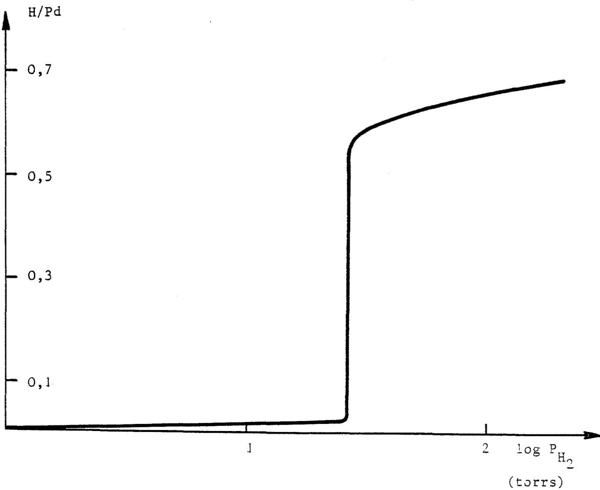
Fig. 13 b - Isotherme  $\text{Pd} - \text{H}_2$  d'après (52)  $50^\circ\text{C}$
