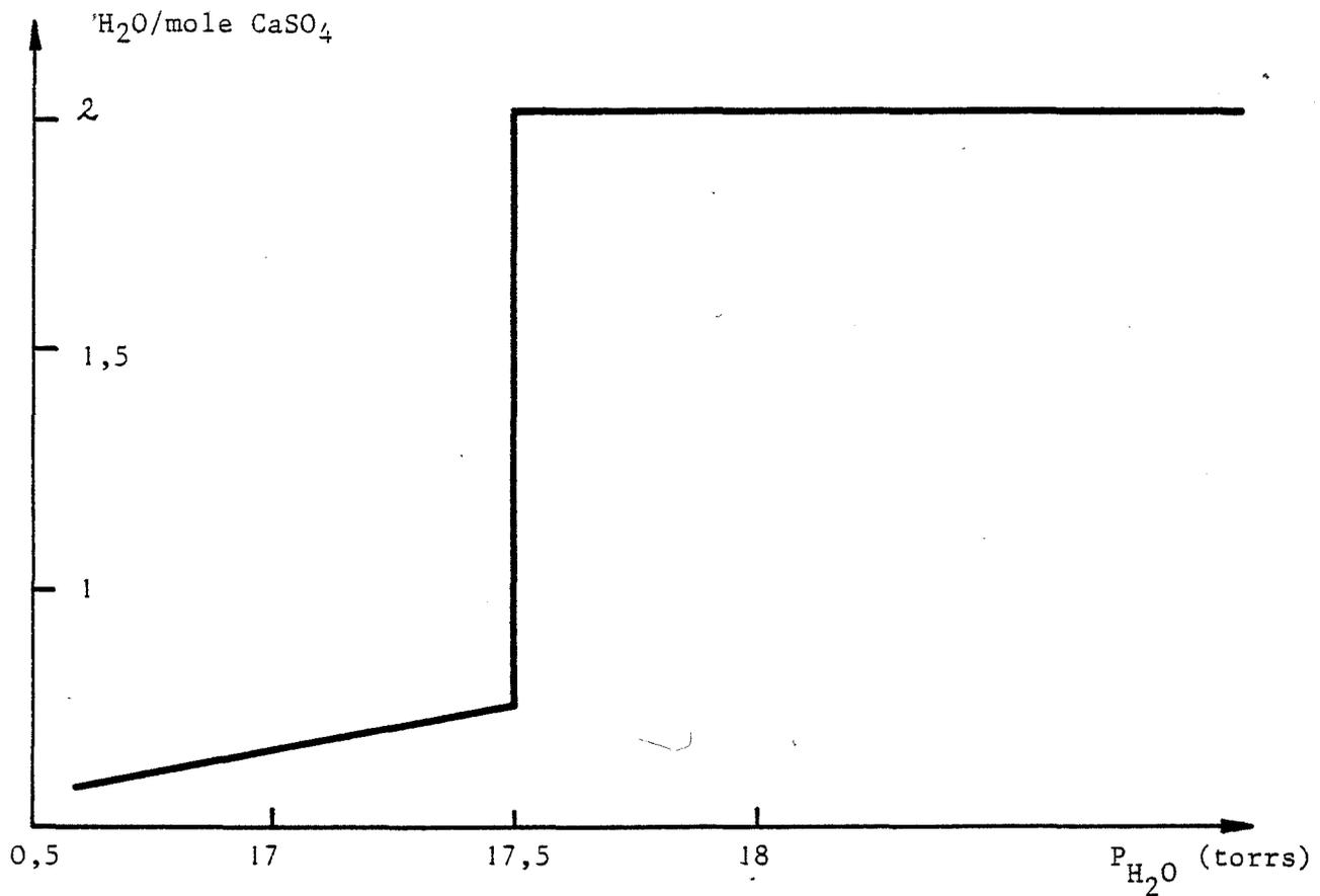
Fig. 13 a - Isotherme  $\text{CaSO}_4 - \text{H}_2\text{O}$  vapeur -  $22^\circ\text{C}$
