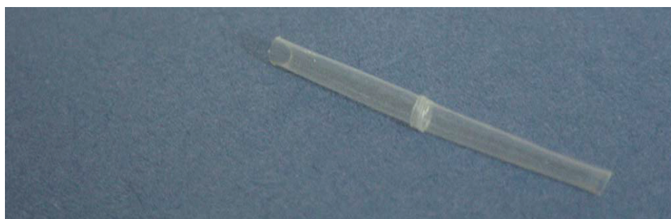
Figure 4.9 Exemple de fibre creuse déshydratée par traitement thermique ( 50^\circ\text{C} ) avec l'utilisation d'un moule tubulaire pendant le séchage.
