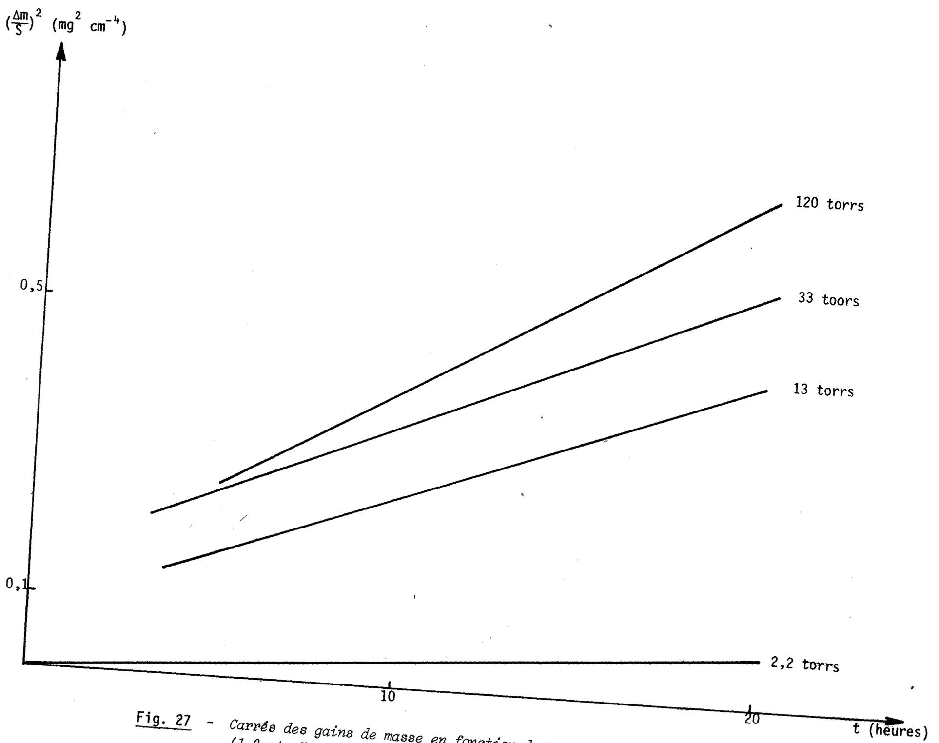
Fig. 27 - Carrés des gains de masse en fonction du temps pour différentes pressions d'oxygène (1,8 at. % Mo -  $T = 780^\circ\text{C}$ ).
