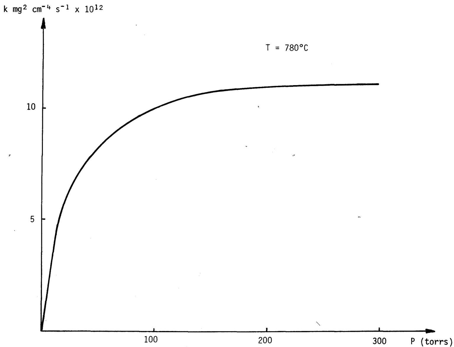
Fig. 28 - Variation de la constante d'oxydation parabolique en fonction de la pression d'oxygène de l'atmosphère oxydante (1,8 at. % Mo -  $T = 780^\circ\text{C}$ ).
