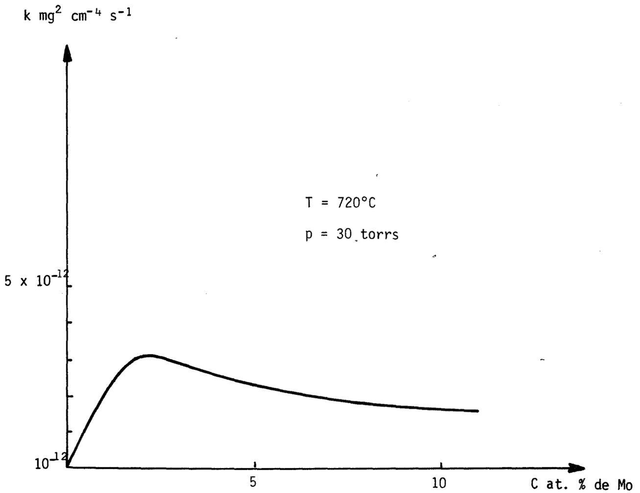
**Fig. 31** - Variation de la constante d'oxydation parabolique en fonction de la teneur en molybdène de l'alliage ( $T = 720^\circ\text{C}$ ,  $P = 30 \text{ torrs}$ ).
