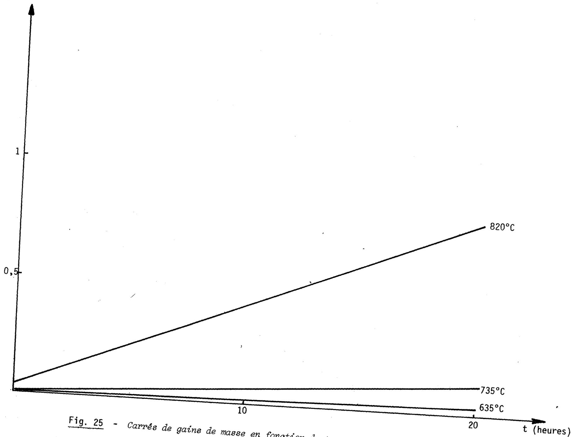
Fig. 25 - Carrés de gains de masse en fonction du temps (12,2 at. % Mo - P = 30 torrs).
