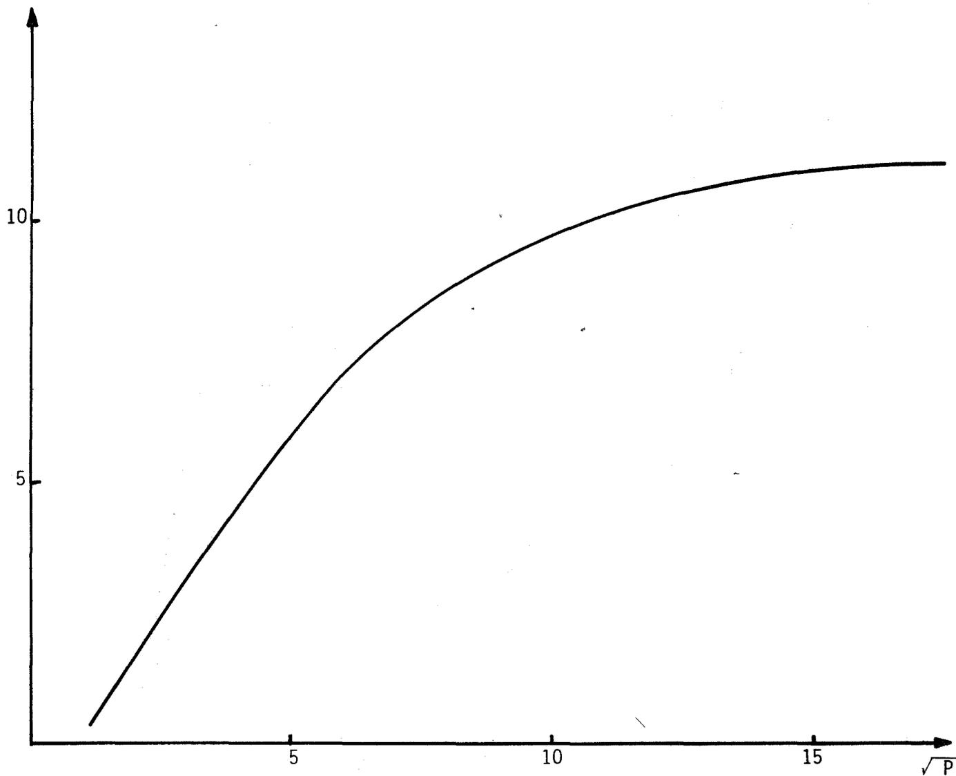
Fig. 29 - Influence de la pression d'oxygène sur la constante de vitesse (1,8 at. % Mo -  $T = 780^\circ\text{C}$ ).
