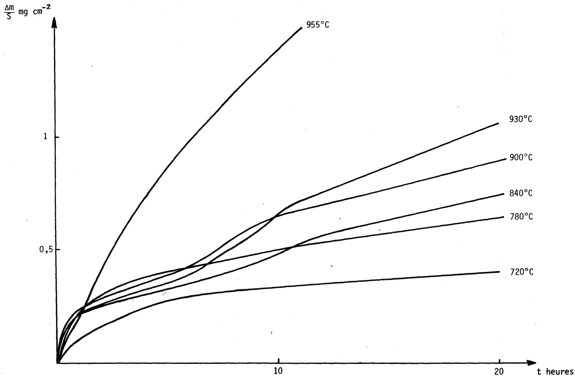
**Fig. 18** - Gain de masse en fonction du temps lors de l'oxydation de l'alliage Ni-Mo (0,6 at. % Mo - P = 30 torrs).
