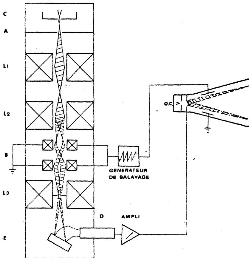
**Fig. 10** - Schéma de principe du microscope électronique à balayage.
