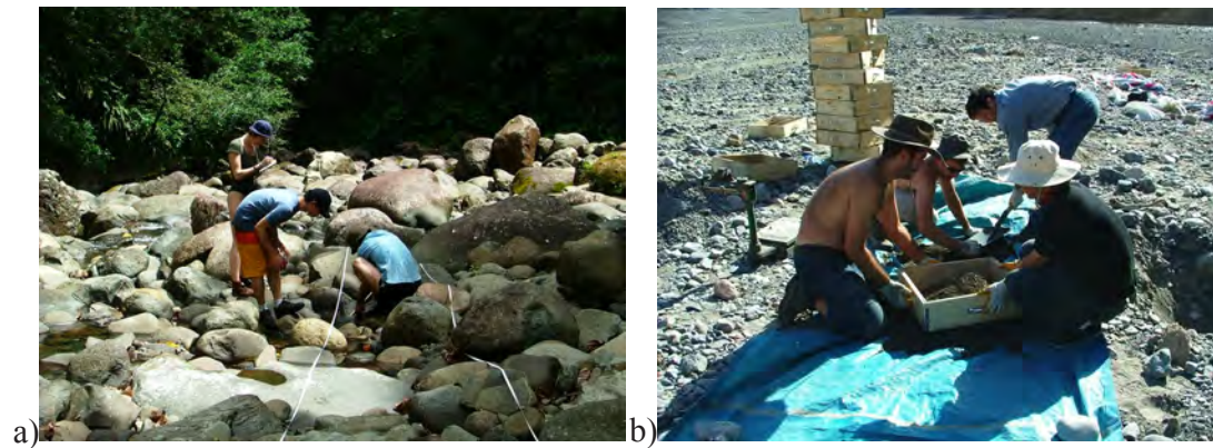
FIGURE 2.21 – Dispositifs de mesure des fractions granulométriques à la surface de lit de rivière asséchée : a) Dispositif de comptage en surface. b) Dispositif d'échantillonnage et tamisage des sédiments du lit.
