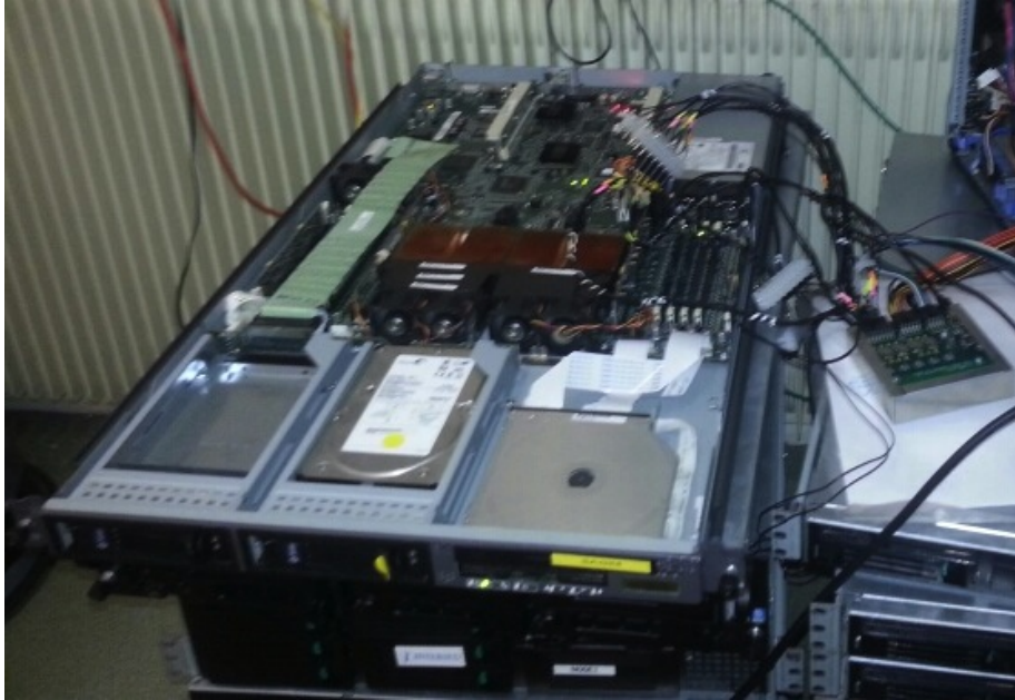
FIGURE 3.25 – Noeud sagittaire-54 sur lequel est branché POWERMON2
