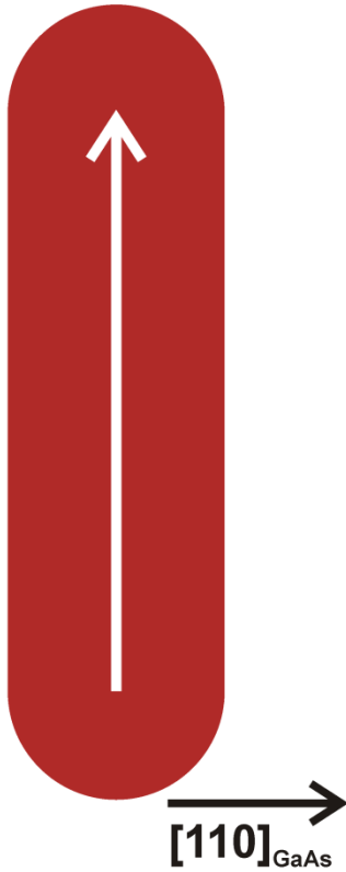
Figure IV.9 : Compétition entre l'anisotropie de forme et l'anisotropie magnétocristalline dans le cas de plots de fer non capés or déposés avec un grand axe perpendiculaire à la direction [110]_{\text{GaAs}} – La densité d'énergie magnétocristalline a été calculée pour les valeurs suivantes des constantes d'anisotropie : K_1^{eff}=8 \text{ kJ.m}^{-3} et K_u^{eff}=2.73 \text{ kJ.m}^{-3} , l'axe facile de \text{Fe}_2 est orienté à 33^\circ de la direction [110]_{\text{GaAs}} (axe de l'analyseur).
