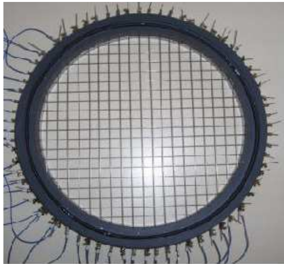
FIGURE 1.3 – Vue du dispositif de tomographie à fils avant implantation
