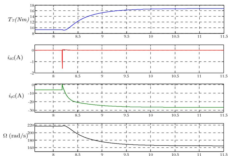
Figure 4.51 Evolution des variables côté génératrice lors de la transition P,Q  $\rightarrow$  V,f pour  $R_{ch}=40\Omega$
