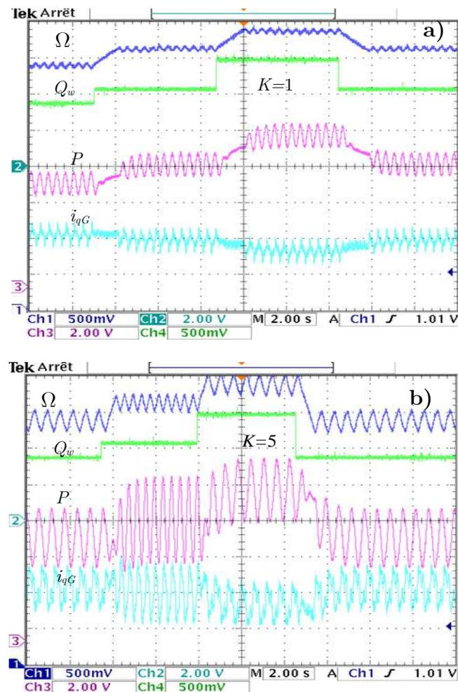
Figure 4.30. Performances du système (capture d'écran d'oscilloscope) pour: a)  $K=1$ ; b)  $K=5$
