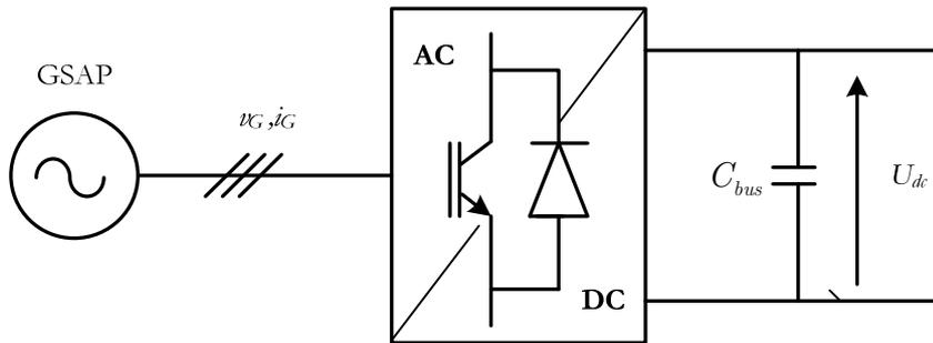
Figure 3.9 Machine synchrone connectée au redresseur à MLI
