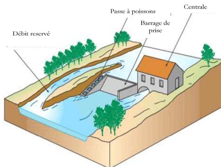
Figure 2.2 Diagramme d'une petite centrale hydraulique au pied d'un barrage [INT-E]
