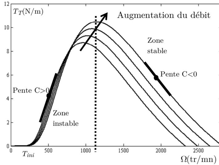
Figure 4.9 Caractéristique couple-vitesse de la turbine pour différentes valeurs de débit
