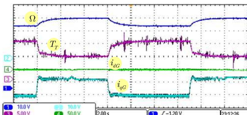
Figure 4.26 Réponse du système pour une variation de charge lors du fonctionnement en mode V,f (capture d'écran d'oscilloscope) Ch 1— Vitesse de rotation ( $\Omega$ , 300Tr/mn/div), Ch 2— Courant actif de la génératrice ( $i_{qG}$ , 10A/div), Ch 3—Couple de turbine hydraulique ( $T_T$ , 4N.m/div), et Ch4 —Courant réactif de la génératrice ( $i_{dG}$ , 0A/div).
