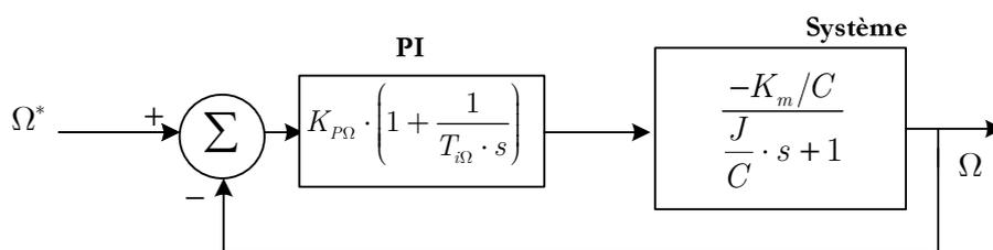
Figure 4.10 Schéma de régulation de la vitesse de rotation de l'ensemble génératrice-turbine hydraulique
