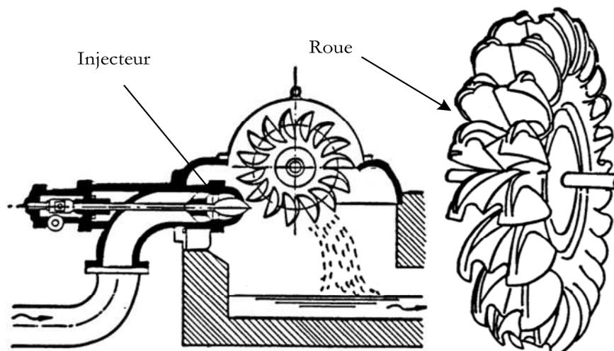
Figure.2.5. Schéma représentatif de la turbine Pelton [Pac-B]
