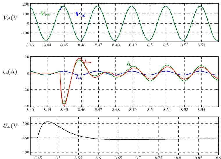
Figure 4.50 Performances dynamiques du système lors de la transition V,f  $\rightarrow$  P,Q pour  $R_{ch}=80\Omega$
