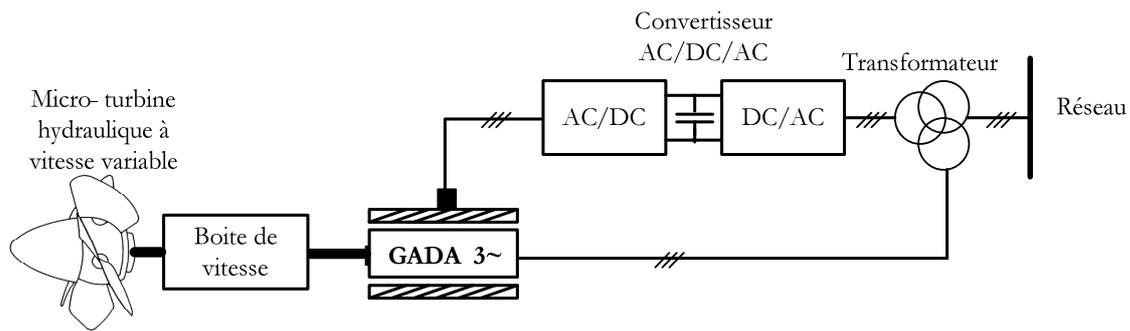
Figure 2.13 Système de génération à vitesse variable basé sur une GADA
