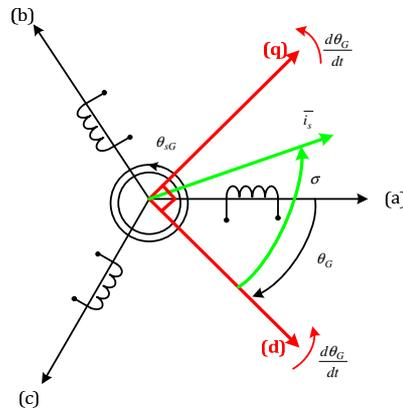
Figure 3.8 Représentation schématique du référentiel tournant
