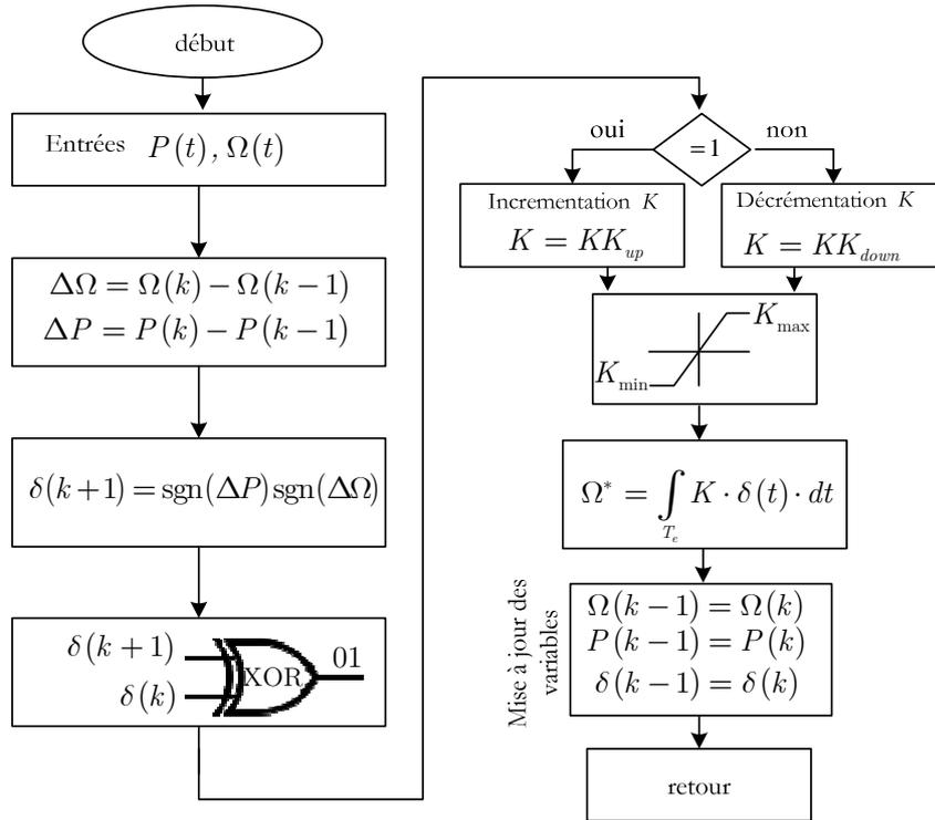
Figure 4.17 Diagramme détaillé de l'algorithme MPPT adaptatif développé.
