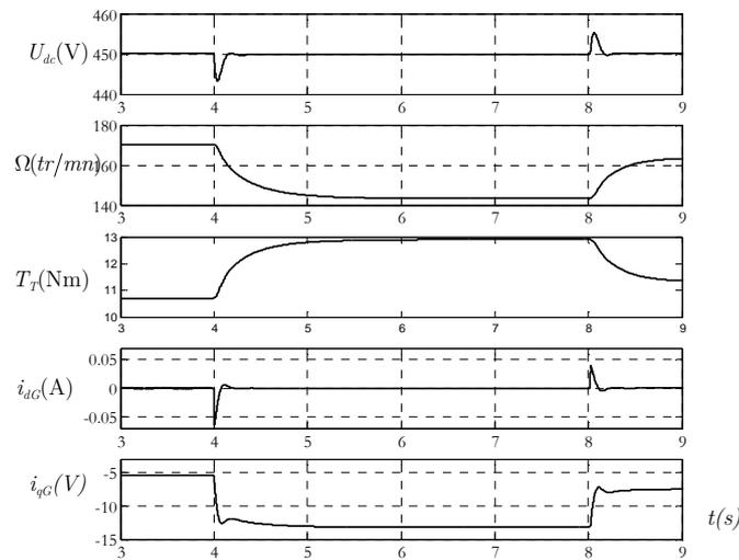
Figure 4.23 Evolution des grandeurs (côté génératrice) en fonctionnement en mode iloté avec variation de la charge
