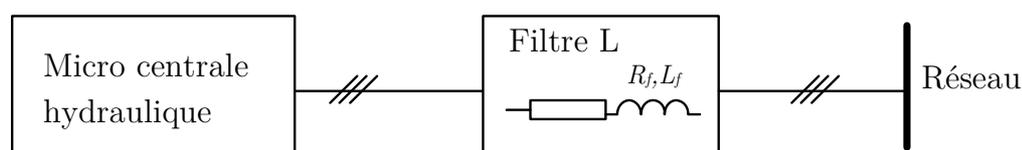
Figure 3.12 Connexion de la microcentrale hydraulique au réseau
