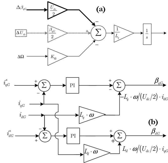
Figure 4.5 Schéma bloc du modèle utilisé pour la synthèse du régulateur de courant sur l'axe q
