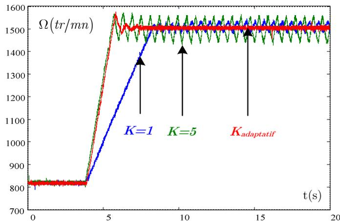
Figure 4.29 Comparaison des performances du MPPT adaptatif et classique : résultats expérimentaux pour la vitesse de rotation
