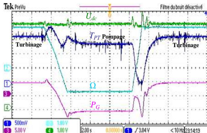
Figure 5.6. Performances de la STEP lors de la transition pompage turbine et vice versa
