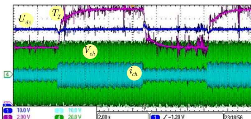
Figure 4.25 Réponse du système pour une variation de charge lors du fonctionnement en mode V,f (capture d'écran d'oscilloscope) Ch 1— Tension du bus-DC ( $U_{dc}$ , 90V/div), Ch 2— Courant de la charge ( $i_{ch}$ , 5A/div), Ch 3—Couple de turbine hydraulique ( $T_T$ , 2N.m/div), et Ch4 — (même zéro que Ch 2) Tension au bornes de la charge ( $V_{ch}$ , 75V/div).
