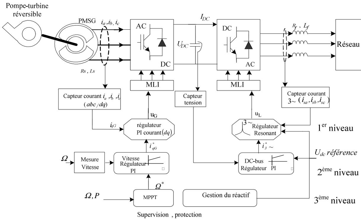
Figure 5.4. Station de pompe-turbine: sous-systèmes et contrôle associé.
