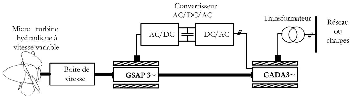
Figure 2.14 Structure de la microcentrale proposée dans [Bre-2008]
