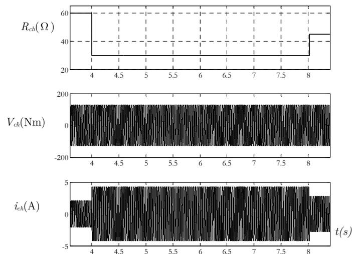
Figure 4.24 Evolution des grandeurs (côté charges) en fonctionnement en mode iloté avec variation de la charge relatif à la figure 4.23
