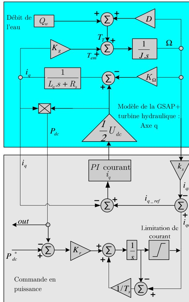
Figure 4.38 Schéma de la structure de régulation de puissance basée sur la boucle de stabilisation de vitesse de rotation (contrôle du courant sur l'axe q)
