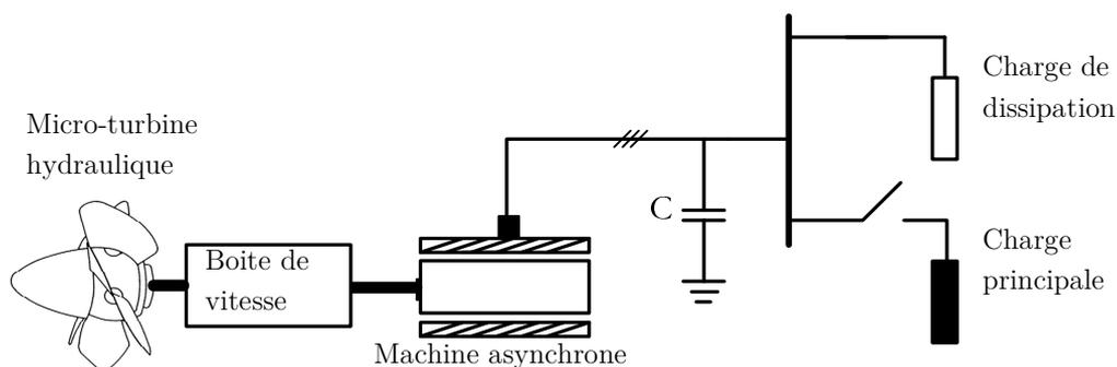
Figure.2.10 Système d'une microcentrale hydraulique sans batteries
