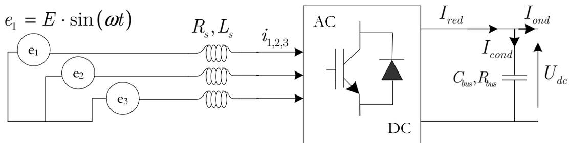
Figure 4.4 Schéma bloc du sous-système côté générateur
