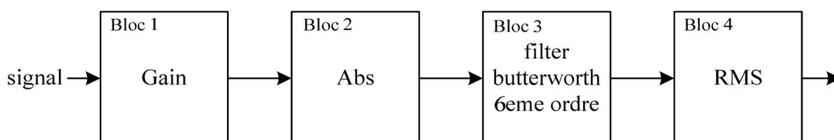
Figure 4.33 Diagramme de démodulation d'amplitude des courants injectés au réseau.
