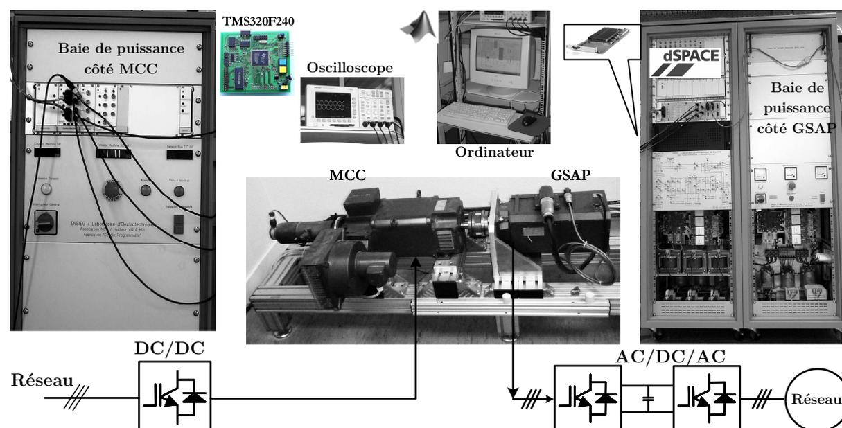
Figure 3.16 Les éléments physiques du banc de test temps réel
