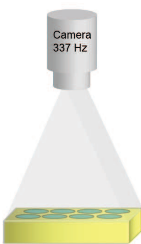
Figure 6: Dispositif Expérimental. Huit boîtes de pétri, placées sous une table de lumière homogène avec une intensité lumineuse de 0.78 \text{ mW/cm}^2 , sont filmées par une caméra rapide (à 337 \text{ Hz} ), pendant 4 minutes
