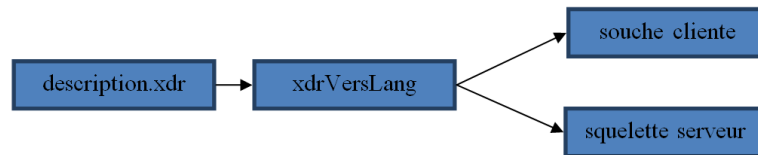
FIGURE 2.5 – Génération de code pour différents langages à partir d’une même description XDR.
