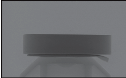
Figure I- 15 : Photographie d’un comprimé dans un tomographe (SH-09kN)
