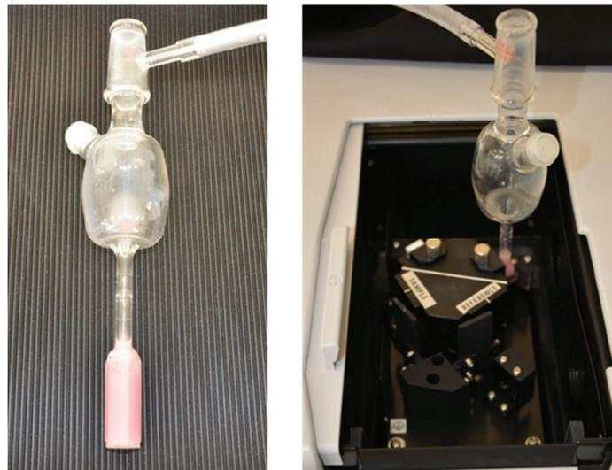
**Figure 2-7.** Photographie du tonomètre contenant 5 mL de solution d'hémoglobine (50  $\mu\text{M}$ ) avec NP de silice (34 mg/mL) (à gauche), placé dans la sphère d'intégration du spectrophotomètre pour mesure (à droite)
