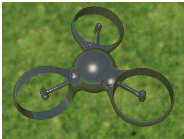
FIGURE 1.3 – Exemple de micro-drone à voilure tournante (Trirotor, Supaero).
