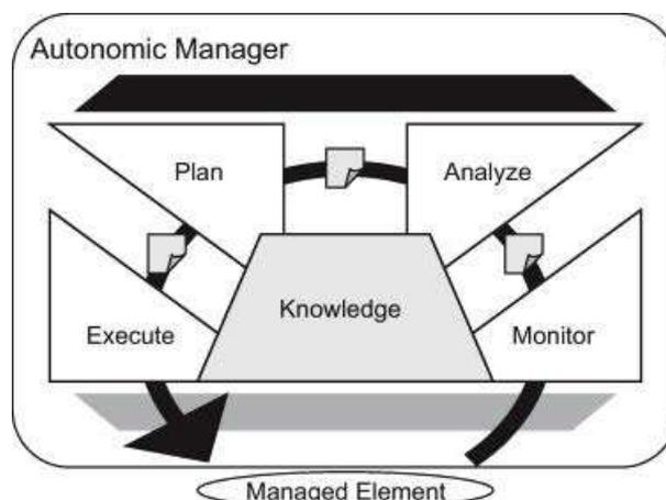
FIGURE 1.3 – Boucle autonome correspondant au modèle MAPE
