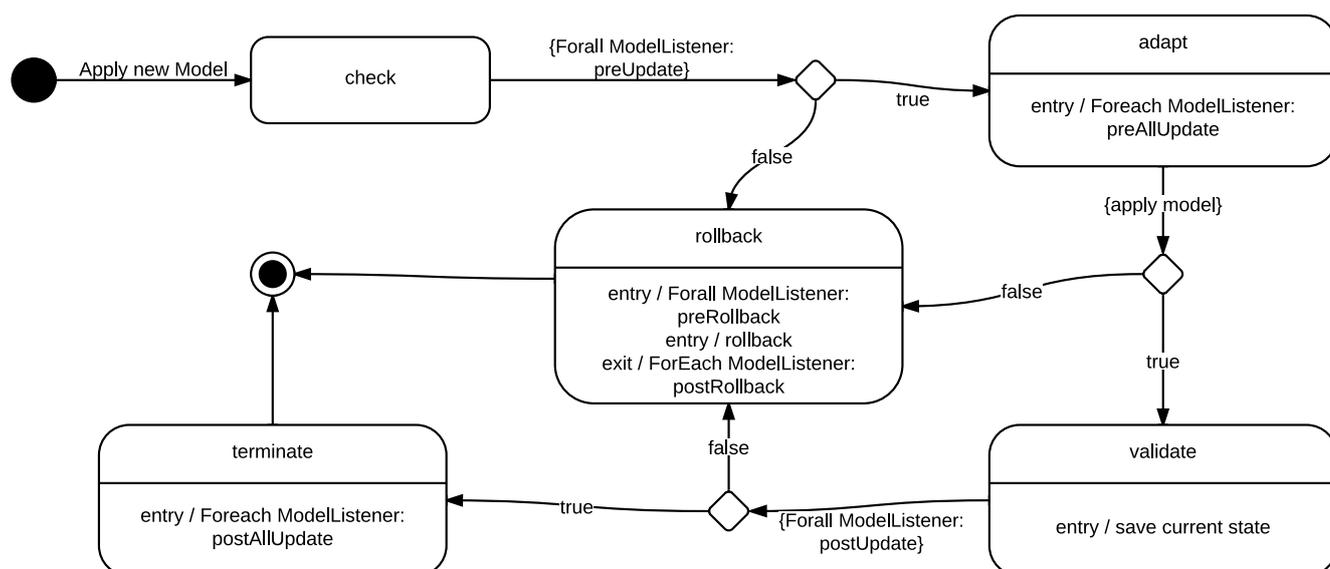
FIGURE 3.3 – Diagramme d'états-transitions montrant l'intégration des *ModelListeners* dans le processus de *Model@Runtime*
