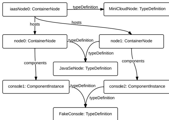
FIGURE 4.2 – Diagramme d'instance pour l'hébergement du serveur web
