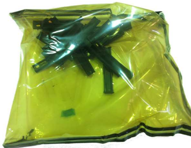
FIGURE 4.8 – Sachet en polyamide contenant les éprouvettes sous atmosphère azotée, pour le vieillissement thermique de cinq jours à 130°C.
