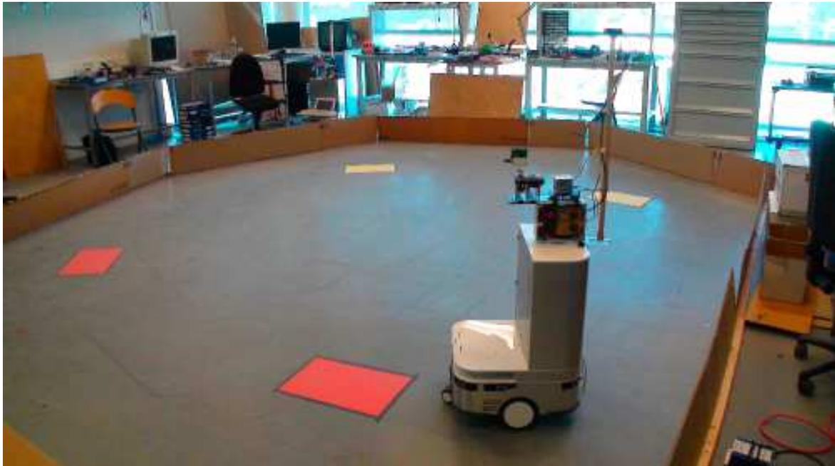
FIGURE 1.4 – Le robot dans son environnement. Les repères au sol ne sont pas visibles depuis la caméra qui ne perçoit que ce qui est plus haut que le niveau du sol.
