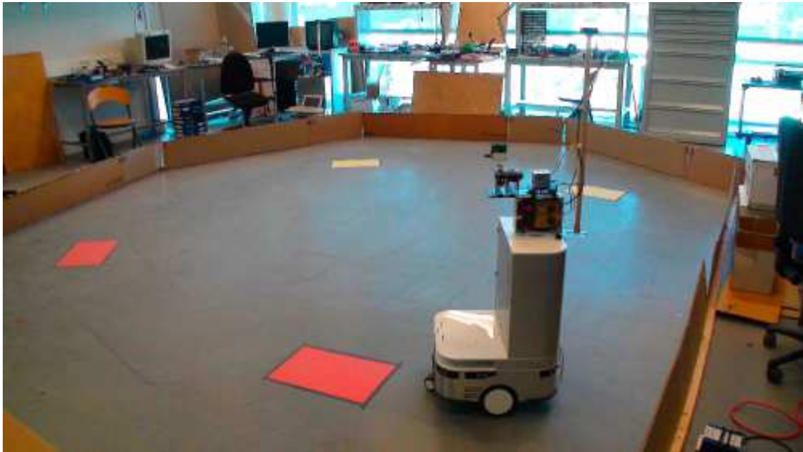
FIGURE 1.4 – Le robot dans son environnement. Les repères au sol ne sont pas visibles depuis la caméra qui ne perçoit que ce qui est plus haut que le niveau du sol.
