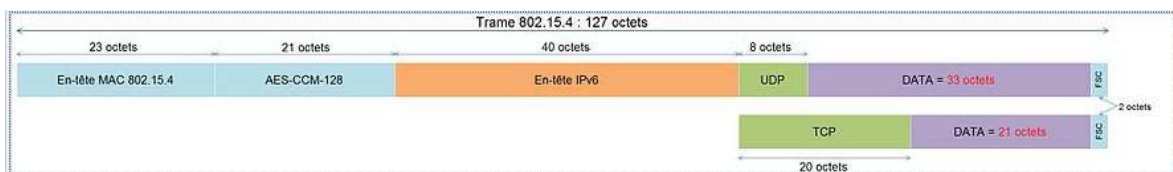
Figure VI.2: Représentation d'une trame de données 6lowPAN [99]
