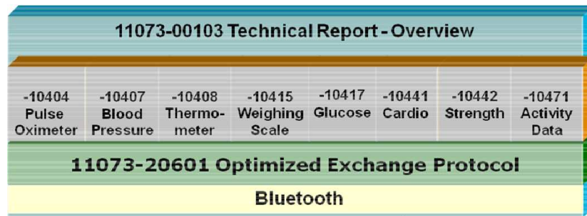
Figure II.7: Les couches du standard IEEE 11073 pour Bluetooth (HDP [11])
