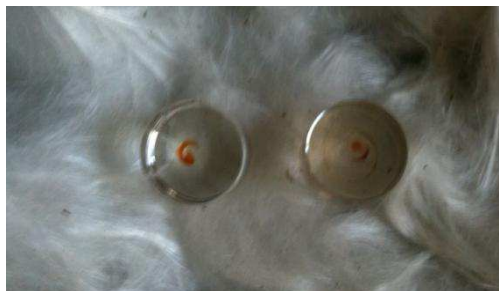
Photographie IV-1 : Saphirs de la cellule HP Systems recouverts d'un dépôt après irradiation à 250°C (P = 25 MPa).
