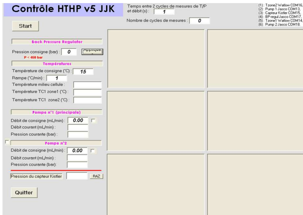
Figure III-5 : Capture d'écran de l'interface du logiciel de commande de la cellule HTHP écrit en Visual basic.
