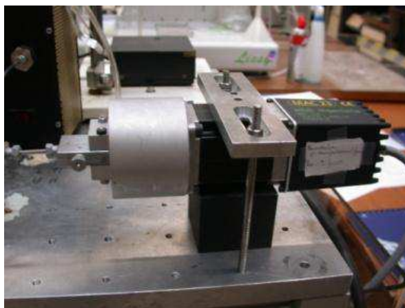
Photographie III-4 : Vanne pilotée à moteur « brushless ».
