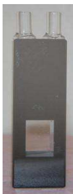
Photographie III-13 : Cellule optique d'irradiation à circulation utilisée lors de la radiolyse stationnaire à température ambiante. Trajet optique : 9 mm.
