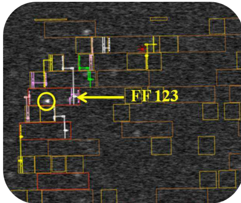
Figure 98 : LVI 2nd harmonique sur le signal de donné à 0.96V
