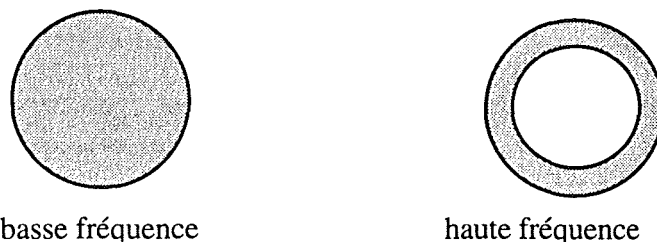
Figure V.1 : Densité de courant dans un conducteur cylindrique éloigné d'autres conducteurs
