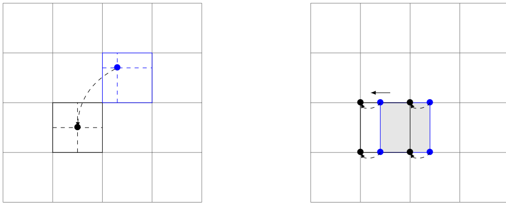
FIGURE 1.4: A gauche : la méthode semi-lagrangienne ponctuelle en arrière, et à droite : la méthode semi-lagrangienne conservative utilisée avec splitting directionnel.
