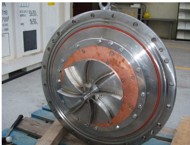
FIGURE I.12 – Turbine TM73 en fer doux de l'expérience VKS montée sur le flasque de la cuve.
