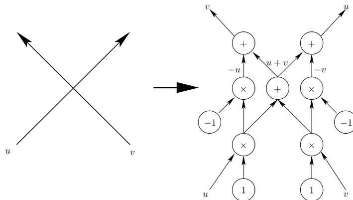
FIG. 6.2: Gadget de planarisation pour les circuits asymétriques.
