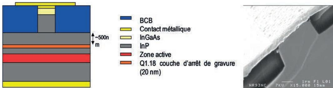
Figure 3-7 : structure du laser après application des étapes technologiques, à droite une image MEB.
