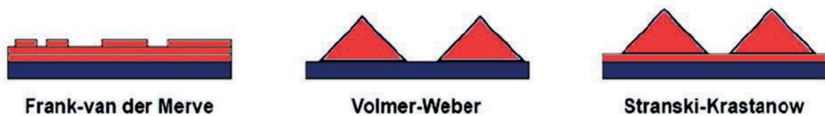
Figure 2-7 : Les trois modes de croissance : Frank-van der Merwe (FM), Volmer Weber(VW) et Stranski-Krastanov (SK).
