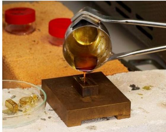
Figure II.5 : Coulée du verre synthétisé sous atmosphère d'air.
