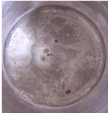
**Figure II.33 :** *Etat de surface du creuset en platine après une synthèse à partir de paratellurite fabriquée au laboratoire. On observe au fond du creuset le dépôt-protecteur. (Diamètre du creuset 50 mm).*
