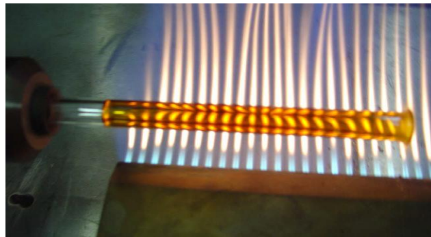
Figure III.2 : Dispositif pour fabrication des capillaires du verre de tellurite par rotational casting [20].
