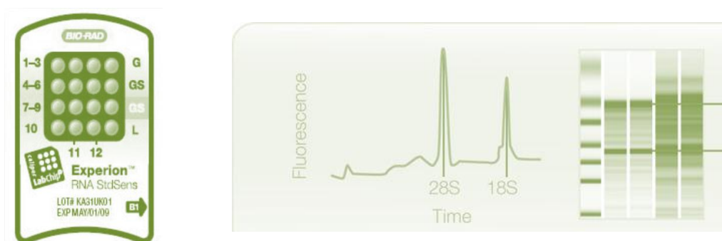
Figure 26 : puce pour l'Experion™ et résultat type : profil et électrophorogramme (gel virtuel)
