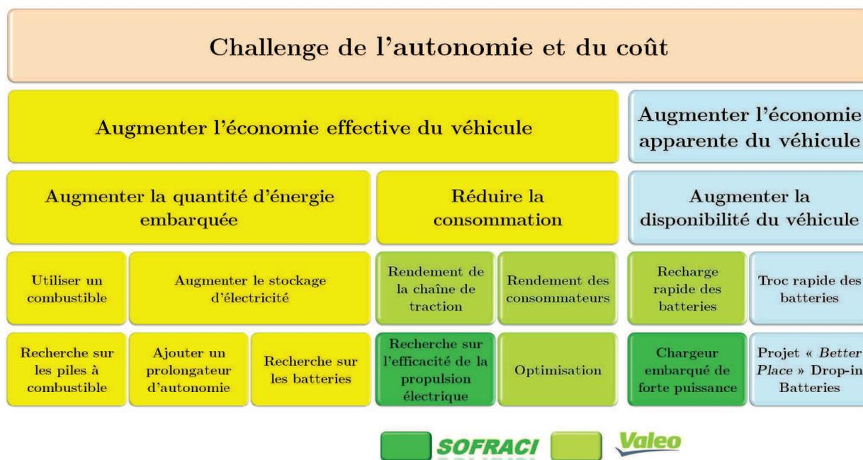
Figure I-5 : Organigramme du challenge de l'autonomie et du coût des véhicules électriques
