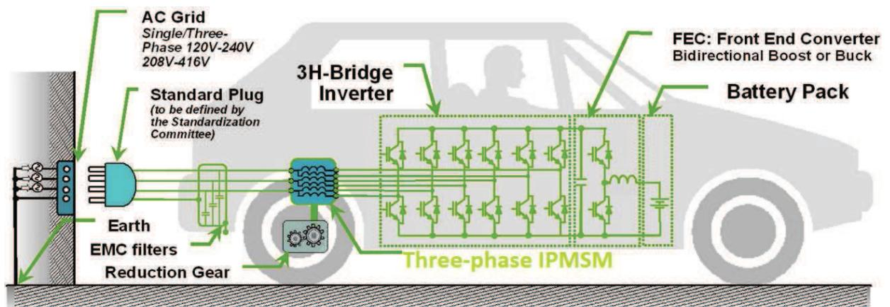
Figure I-10 : Système complet SOFRACI détaillé
