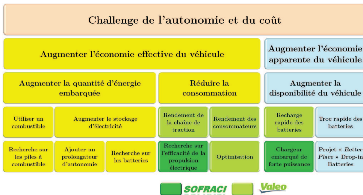
Figure I-5 : Organigramme du challenge de l'autonomie et du coût des véhicules électriques
