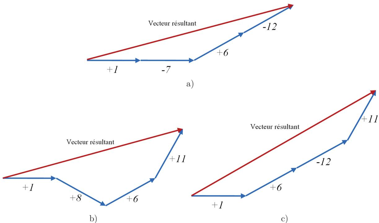
Figure II-4 : Vecteur résultant du fondamental électrique de la topologie 12/10 avec trois configurations : a) 2-2, b) 3-1 et c) 4-0
