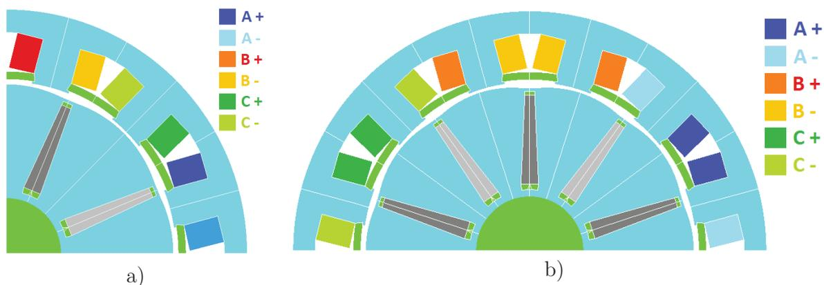
Figure III.9 : Bobinage des 2 machines : a) 12/8 et b) 12/10
