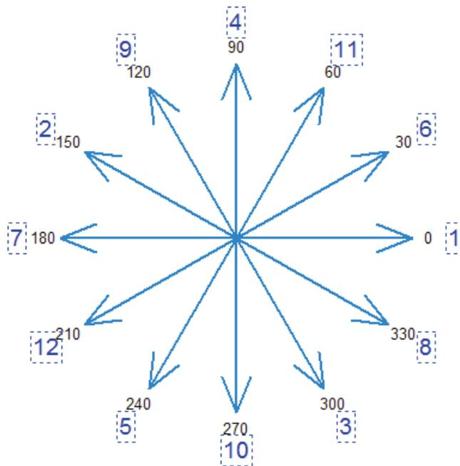
Figure II-1 : Étoile des encoches de la topologie 12/10
