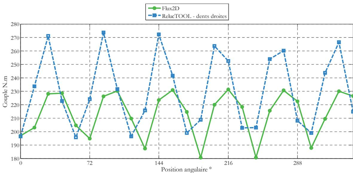
Figure IV.7 : Couple magnétique – méthode dents droites et *Flux2D*
