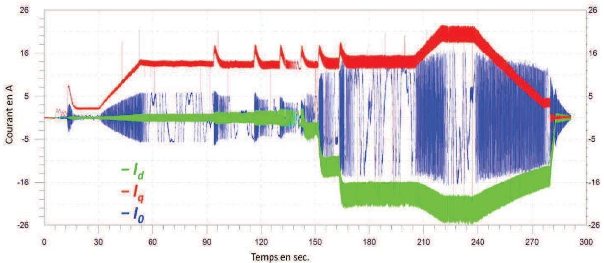
Figure I-19 : Résultats de mesures pour les courants ( $I_d$ ,  $I_q$  et  $I_0$ ) du moteur en charge en fonction du temps
