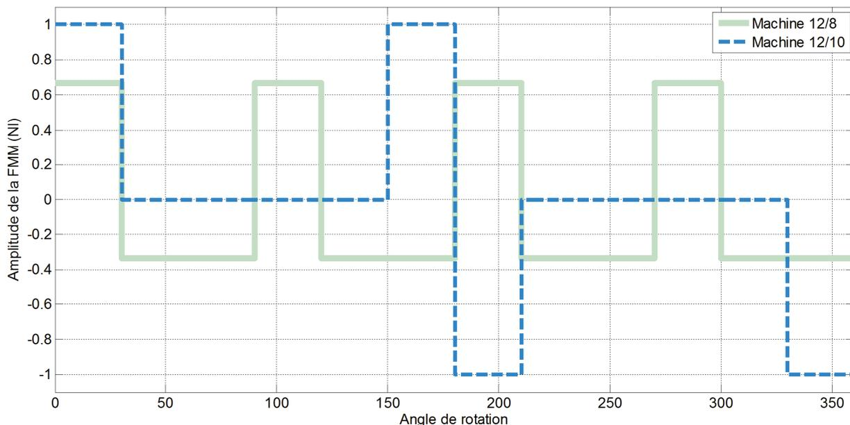
Figure III.3 : Fonctions de bobinage des machines 12/8 et 12/10
