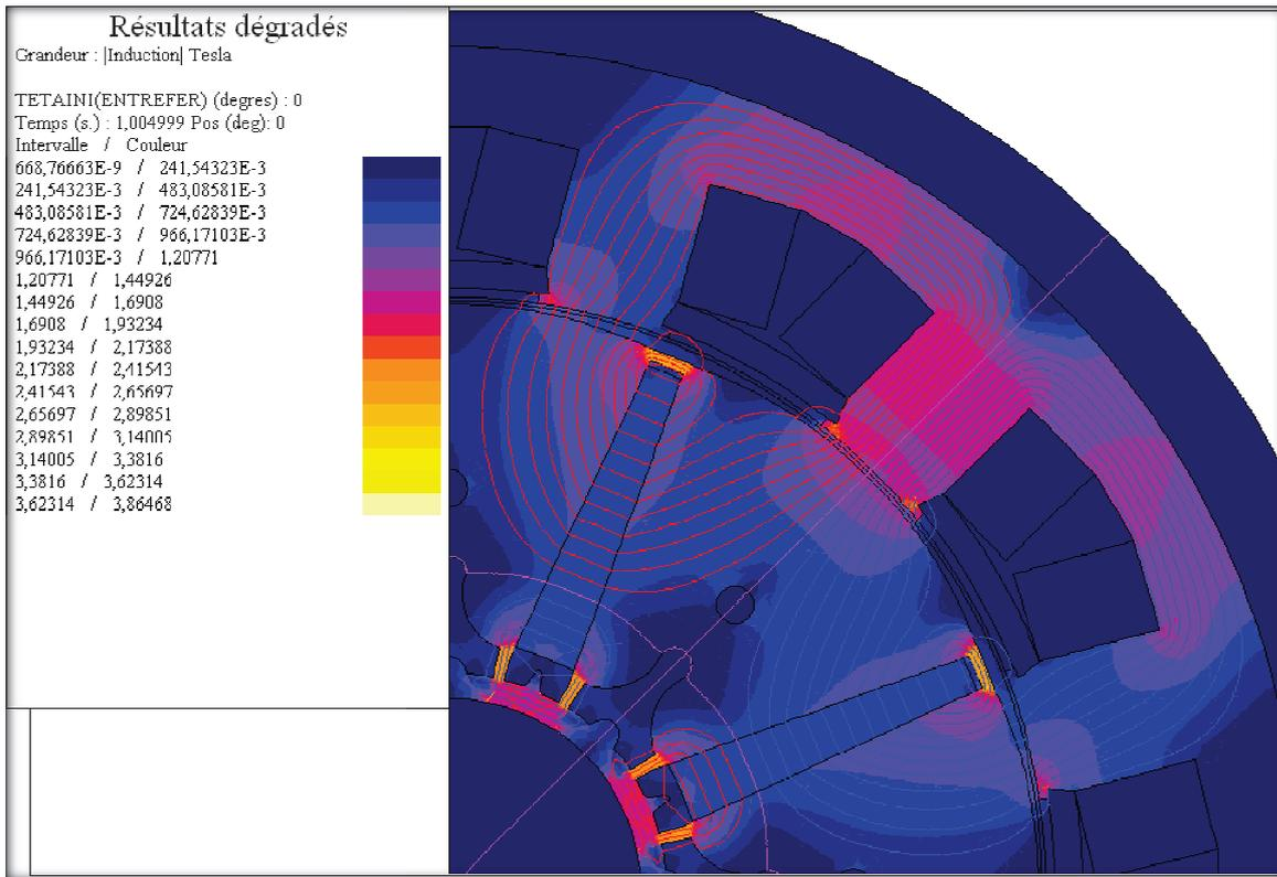
Figure IV.2 : Equiflux et niveau d'induction de la machine 12/8 en charge
