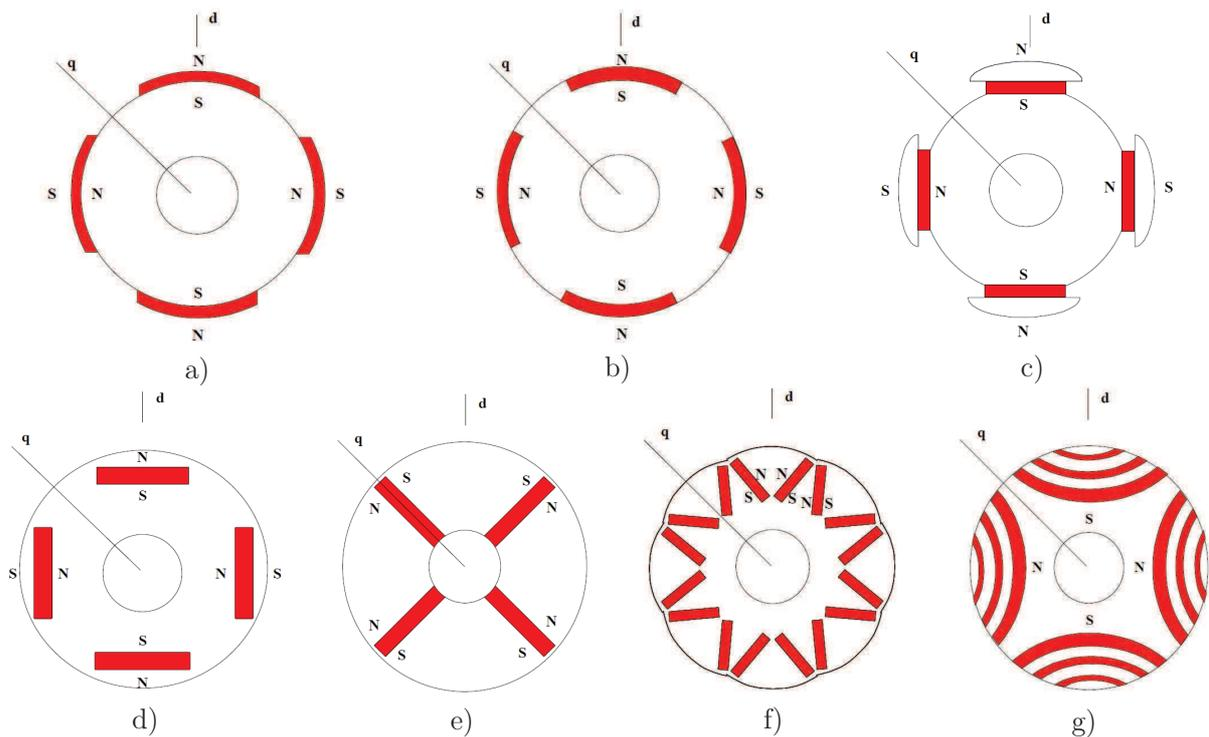
Figure I-26 : Localisation des aimants permanents : a) Aimants montés en *surface*, b) Aimants insérés à la *surface* du rotor, c) Aimants en *surface* avec épanouissement polaire, d) Aimants *enterrés* tangentiels, e) Aimants *enterrés* radiaux ou à concentration de flux, f) Aimants *enterrés* en V avec entrefer variable, et g) Machine à réluctance variable assistée par des aimants permanents *enterrés* [HEI-02]
