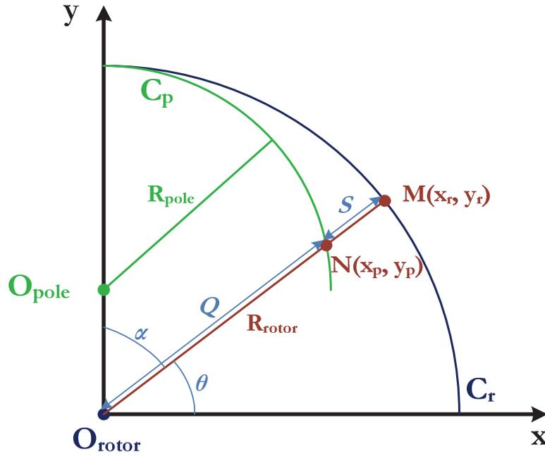
Figure IV.17 : Cercles du rotor et d'un pôle rotorique
