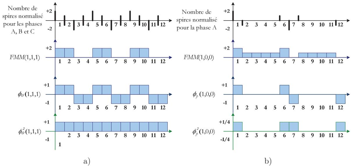
Figure III.8 : Méthode graphique du calcul du ratio de l'inductance homopolaire – Machine 12/10 :
