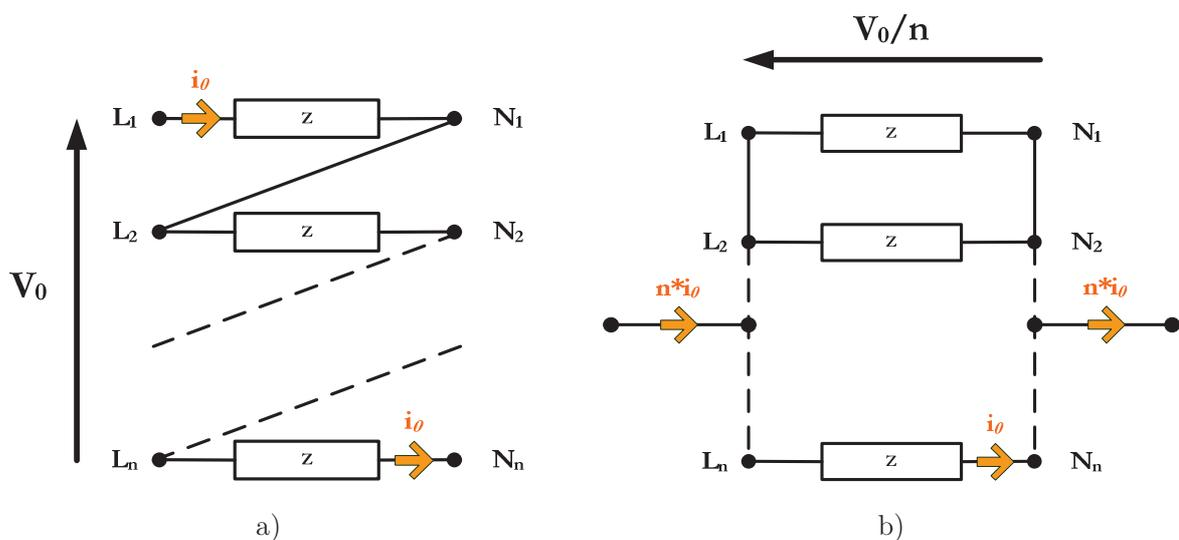
Figure III.5 : Méthodes de mesures de l'inductance homopolaire : a) série et b) parallèle
