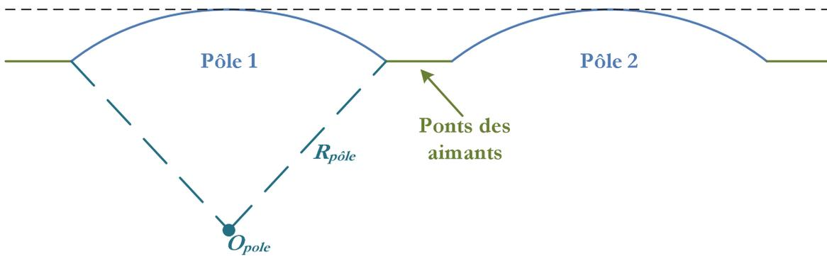
Figure IV.15 : Forme du bombage des pôles du rotor
