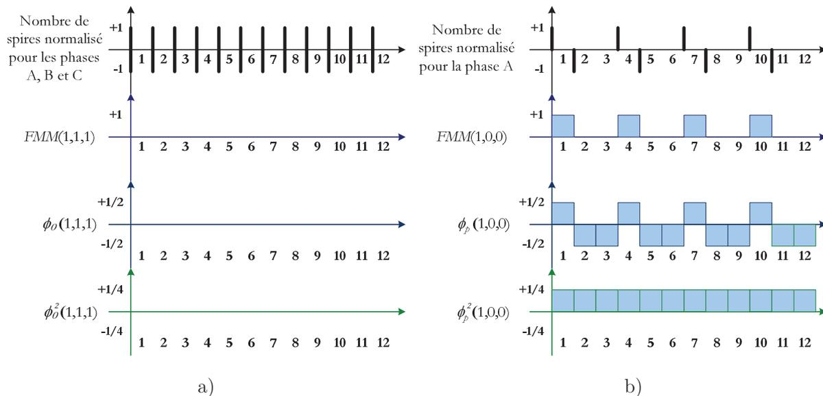
Figure III.7 : Méthode graphique du calcul du ratio de l'inductance homopolaire – Machine 12/8:
