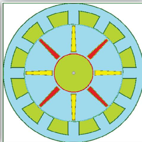
Figure V.3 : Géométrie initiale de la machine 12/8
