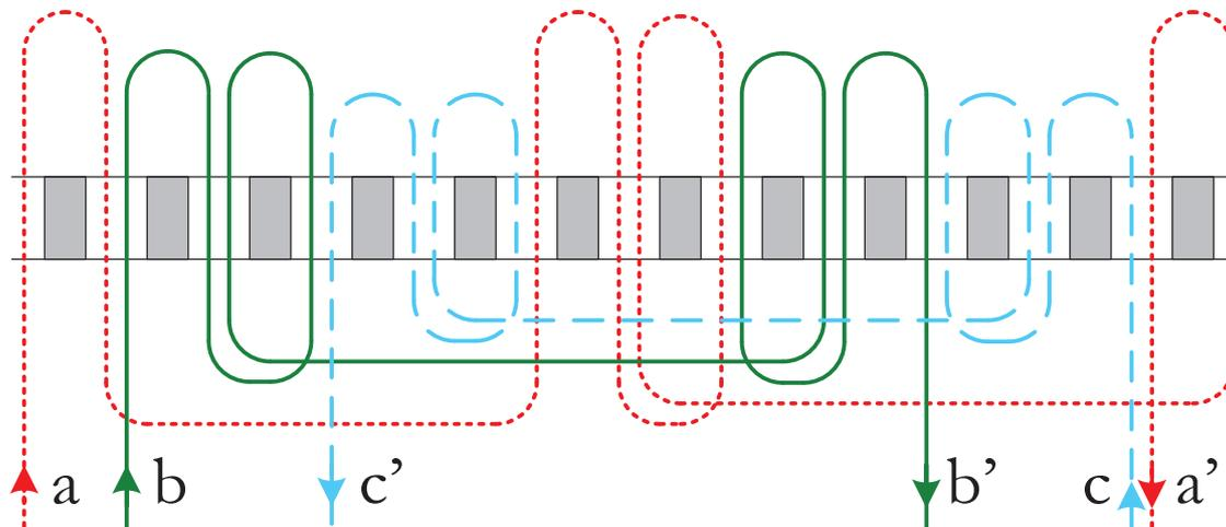
Figure III.2 : Bobinage de la machine 12/10 (configuration 2-2)
