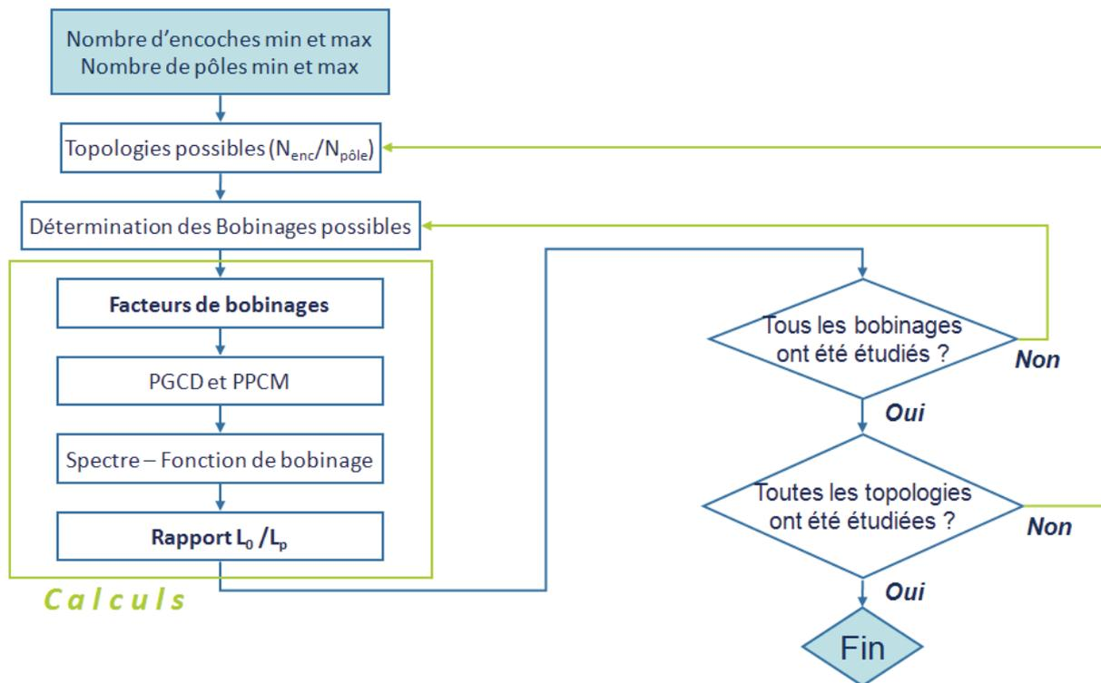
Figure III.12 : Organigramme du modèle analytique sous Matlab
