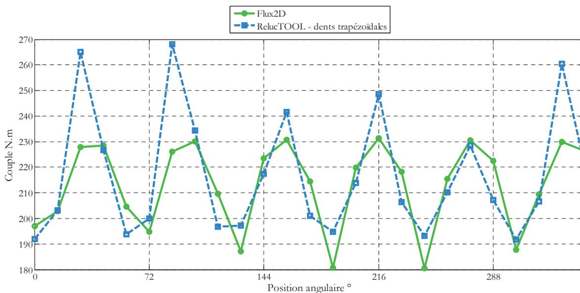
Figure IV.10 : Couples : Méthode dents trapézoïdales et Flux2D
