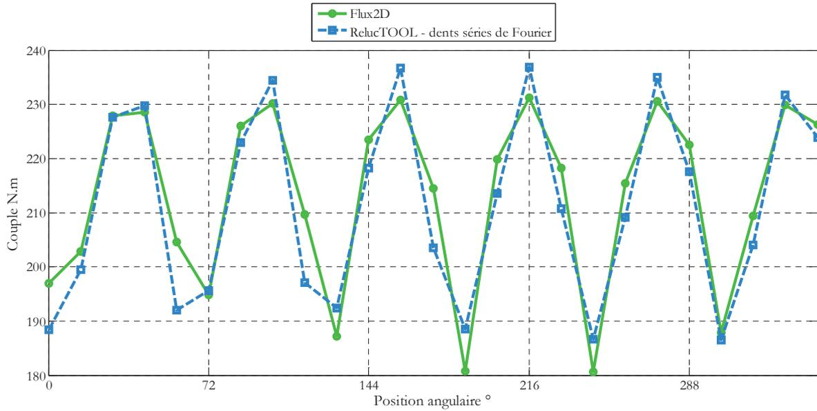
Figure IV.13 : Couples : Méthode séries de Fourier et Flux2D
