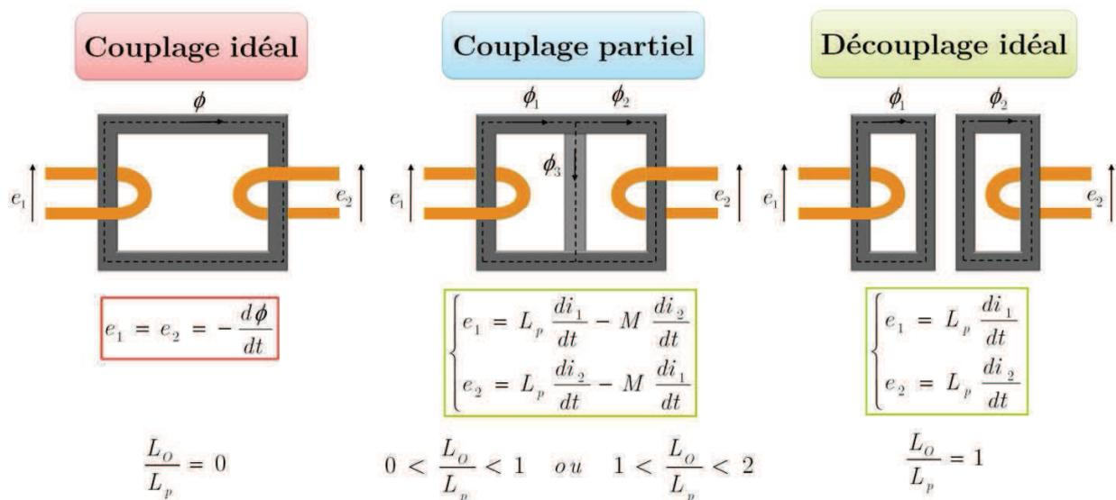
Figure I-13 : Types de couplage entre phases
