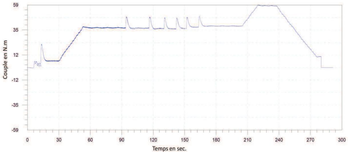
Figure I-18 : Résultats de mesure pour le couple de charge du moteur en fonction du temps
