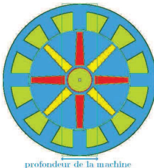
Figure V.7 : Géométrie optimale de la machine 12/8 : Volume minimisé
