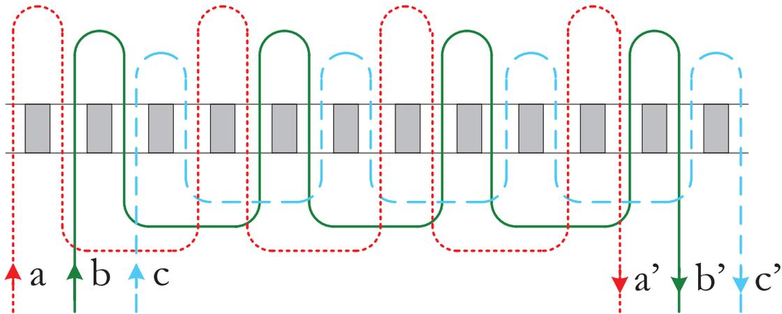
Figure III.1 : Bobinage de la machine 12/8 (configuration 4-0)
