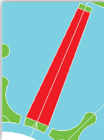
Figure I-24 : Forme des aimants trapézoïdaux brevetés par *Leroy-Somer*
