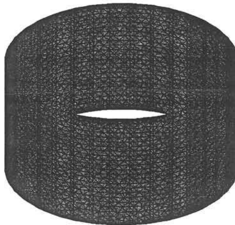
Figure 41 : Maillage de l'entrefer par des éléments surfaciques
