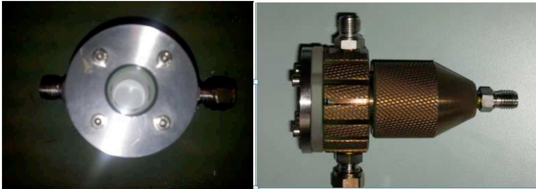
Figure II.8. Images du réacteur utilisé pour réaliser les tests d'activité photocatalytique.
