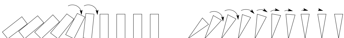
FIGURE 5.3 – Deux fronts de chutes de dominos. A gauche, on est dans une situation bistable (la position verticale du domino est stable) et le front est un front poussé : la chute des dominos ne se fait qu'à cause de l'arrivée du front de chute par la gauche. A droite, on est dans une situation monostable (la position verticale est instable). En ajustant bien les dominos au départ dans une position très proche de la verticale, chaque domino chute et l'ensemble de ces chutes forme un profil se déplaçant à vitesse constante, c'est-à-dire un front. Il s'agit d'un front tiré car la chute d'un domino n'est pas provoquée par un contact avec les autres, une information venant de la gauche, mais seulement par le comportement local du domino, connu bien avant l'arrivée du front. La vitesse d'un tel front peut être aussi grande que voulue.
