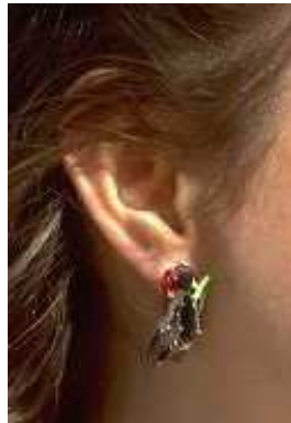
FIGURE 4.11 – Boucle d'oreille captant la pression sanguine
