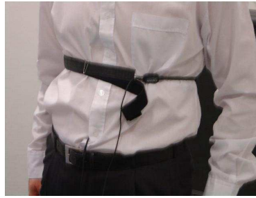
FIGURE 1.8 – capteur de respiration [Williams 2004]
