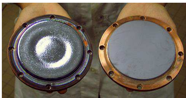
Figure 31. Photo montrant une cible neuve (à droite) et une cible utilisée en pulvérisation magnétron (à gauche).
