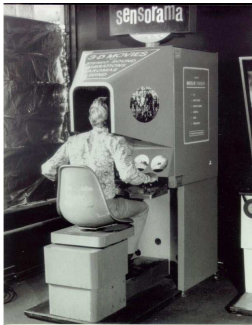
FIG. 1.3 – Sensorama Simulator par Heilig, 1962
