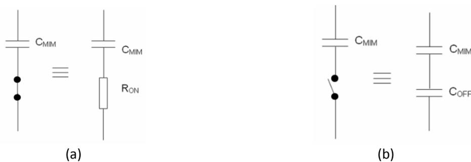
Figure 7 : Etats de la DTC (a) état pour  $V_G=2,5V$ , (b) état pour  $V_G=-1,5V$
