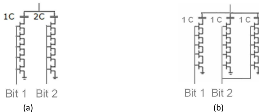
Figure 8 : Exemple d'une DTC à 2 bits (a) implémentation théorique, (b) implémentation réelle
