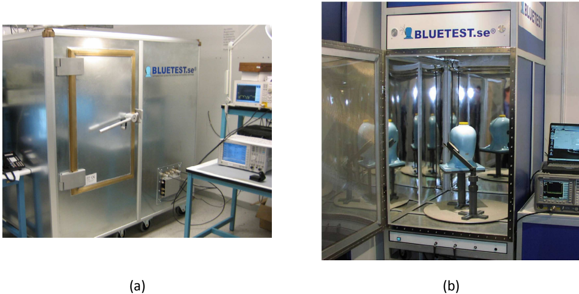
Figure 6 : Chambre réverbérante (a) vue extérieure, (b) vue intérieure [14]
