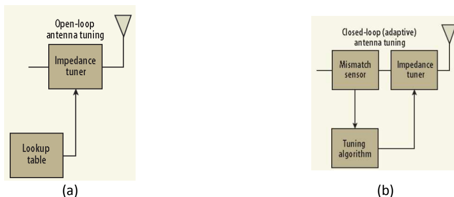
Figure 3 : Types de tuners (a) boucle ouverte, (b) boucle fermée [3]
