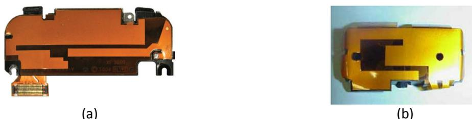
Figure 17 : Exemples d'antennes réalisées en technologie flex (a) extrait de [22], (b) extrait de [27]
