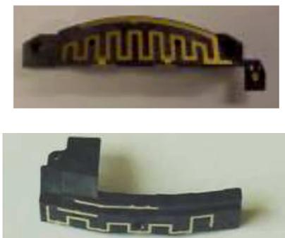
Figure 14 : Exemple de monopoles repliés [24]
