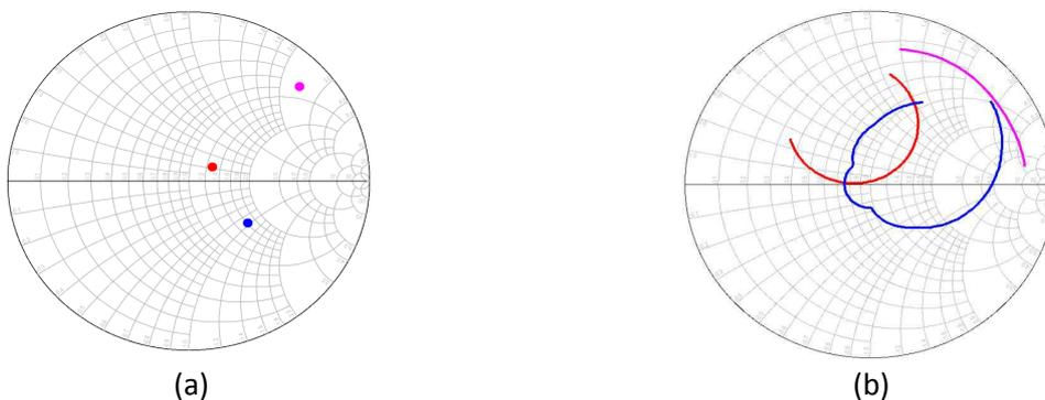
Figure 2 : Effet de la main et du tuner sur le  $S_{11}$ : représentation en abaque de Smith (a) à 892 MHz, (b) sur l'ensemble de la bande basse, entre 820 et 960 MHz
