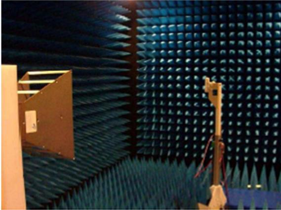
Figure 3: Vue intérieure d'une chambre anéchoïque [6]
