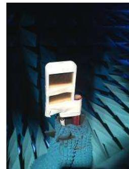
Figure 17 : Mesure d'efficacité avec le boîtier
