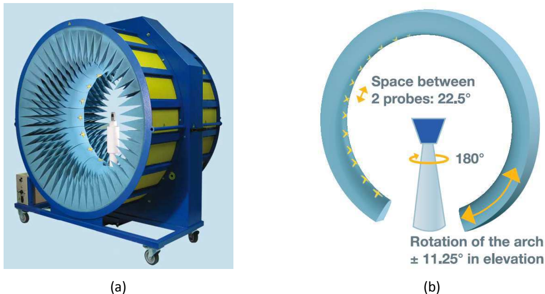
Figure 5 : StarLab (Satimo) (a) photo du modèle 6 GHz, (b) principe de fonctionnement [8]
