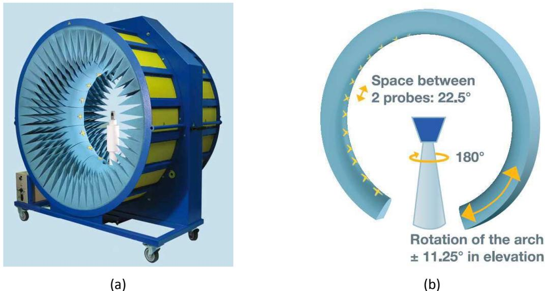
Figure 5 : StarLab (Satimo) (a) photo du modèle 6 GHz, (b) principe de fonctionnement [8]
