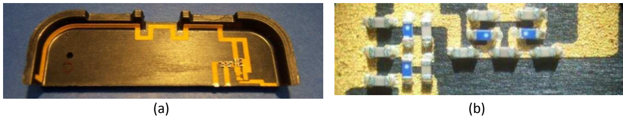
Figure 25 : Prototype d'antenne après assemblage (a) vue d'ensemble, (b) zoom sur les composants
