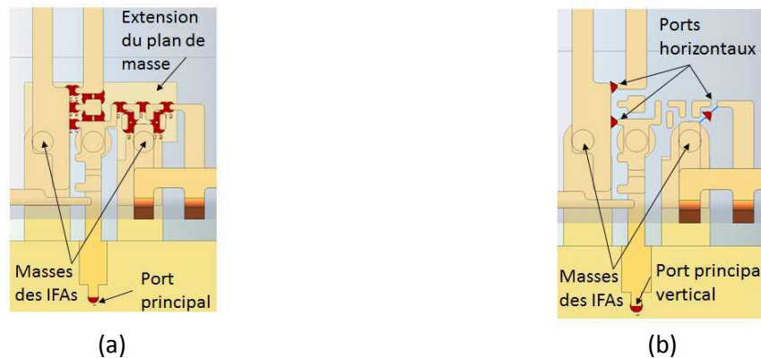
Figure 26 : Simulation du diplexeur plastronique avec CST (a) version avec 29 ports, (b) version simplifiée avec 4 ports
