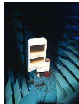
Figure 17 : Mesure d'efficacité avec le boîtier
