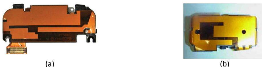
Figure 17 : Exemples d'antennes réalisées en technologie flex (a) extrait de [22], (b) extrait de [27]
