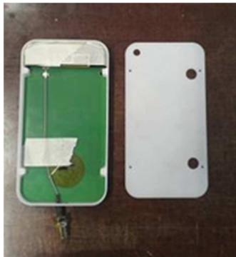
Figure 16 : Boîtier réalisé en matière ABS
