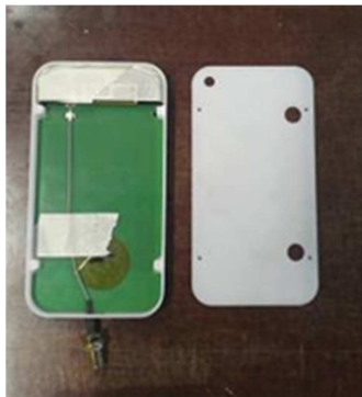
Figure 16 : Boîtier réalisé en matière ABS
