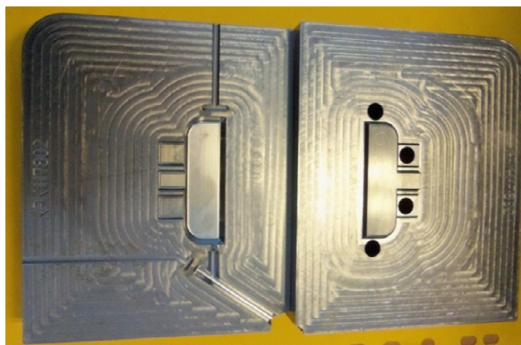
Figure 4 : Moule ayant servi à la réalisation de la pièce plastique
