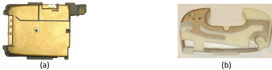
Figure 20 : Exemples d'antennes MID (a) pour applications mobiles [22], (b) GSM produite par Tyco [34]
