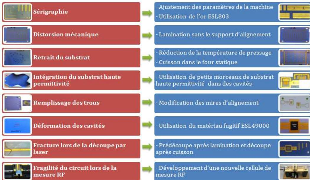
**Figure 3:** Solutions proposées pour les différents problèmes technologiques rencontrés lors de la validation du procédé de fabrication
