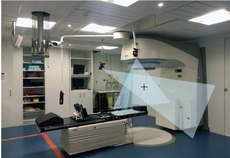
FIGURE 6.22 – Vue d'ensemble du dispositif d'observation composé de deux caméras ToF fixés au plafond à l'aide de systèmes amovibles. Leur position est limitée par le champ de déplacement de l'accélérateur ainsi que par le système laser de repositionnement. Elle est optimisée avec comme critère la plus faible distance d'observation par rapport à l'isocentre et un champ de vue maximal afin d'englober l'ensemble du thorax et de l'abdomen.
