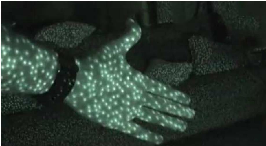
FIGURE 3.1 – Le motif de points infrarouge projeté permet à la Kinect d’estimer une carte de profondeur associant à chaque pixel un point 3D.
