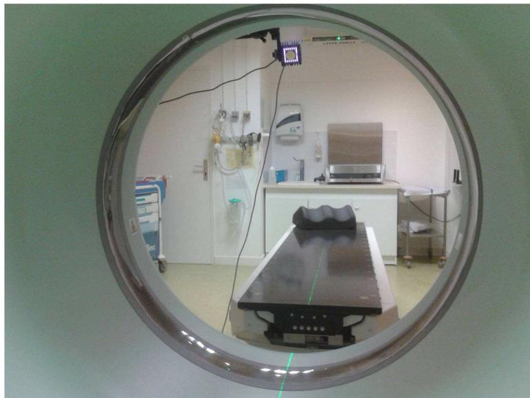
FIGURE 4.15 – Vue du dispositif complet depuis l'arrière du tunnel d'acquisition. Une des difficulté est l'impossibilité de monter plus haut la caméra afin d'avoir un meilleur angle d'observation puisque le tunnel du scanner est arrondi vers l'extérieur.
