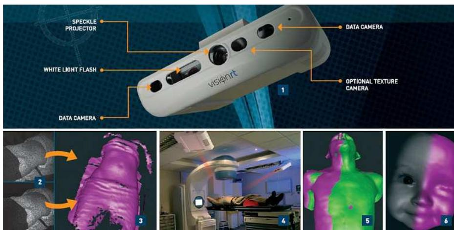
FIGURE 2.8 – Le système commercial AlignRT de VisionRT utilise la lumière structurée pour reconstruire les surfaces en 3D (SiteVisionRT (2013))
