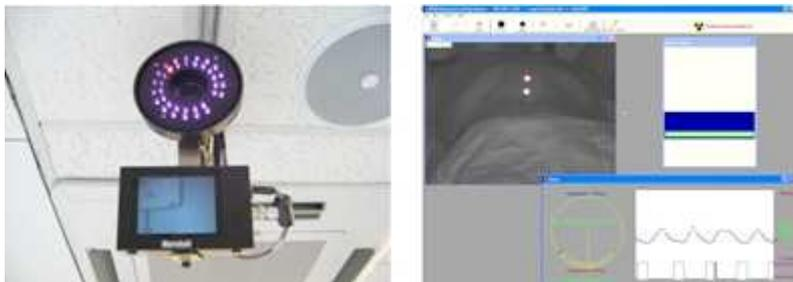
FIGURE 2.4 – Le système infrarouge passif RPM commercialisé par Varian est composé d'un émetteur de lumière infrarouge (à gauche), d'un bloc plastique transparent sur lequel sont fixés deux réflecteurs infrarouges visible sur l'image infrarouge à droite.
