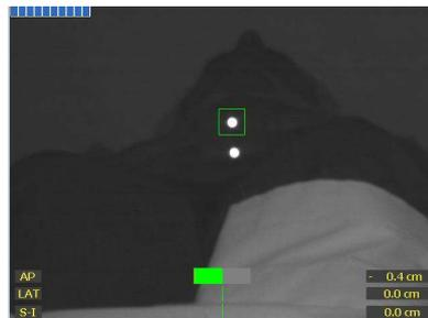
FIGURE 4.12 – Le système RPM de Varian est constitué d'une caméra fixée au bout du lit de traitement qui observe le déplacement de deux marqueurs réfléchissants infrarouges, visibles sur cette image. Le logiciel intégré fournit alors en temps réel une estimation du déplacement dans les trois directions.
