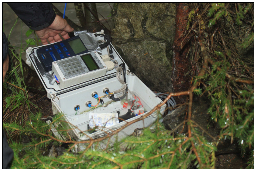
Figure 4.11 : Datalogger enregistrant la conductivité mesurée dans le torrent par le conductimètre WTW 315i (à gauche).
