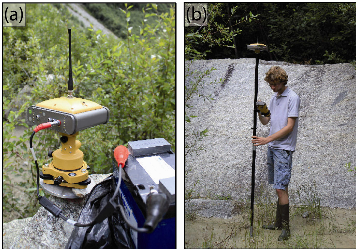
Figure 5.1 : Photographies de l'antenne base (a) et de l'antenne mobile (b) HiPer®Pro (Topcon Positioning systems, Inc.) en fonctionnement sur le plan des eaux du torrent des Bossons.
