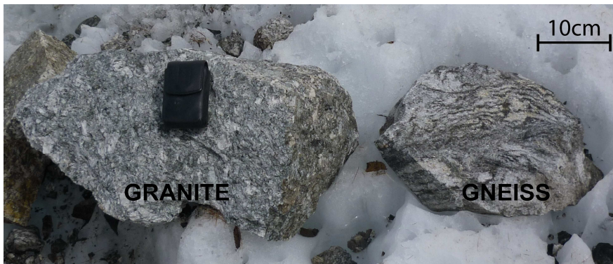
Figure 1.6 : Exemples d'échantillons de granite (à gauche) et de gneiss (à droite) montrant la différence de faciès à l'échelle macroscopique.
