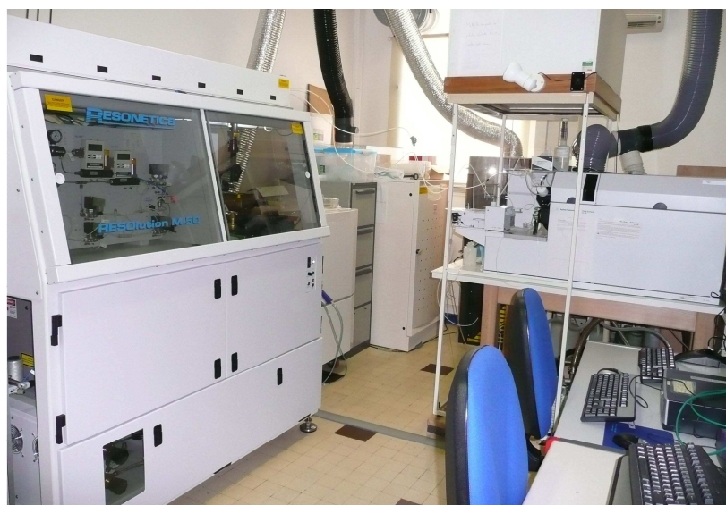
Figure 3.9 : Matériel d'analyse géochronologique par ablation laser (ATL) (à gauche sur l'image) couplée à un ICP-MS (à droite) contrôlé par l'unité (au premier plan) au laboratoire LMV, Université de Clermont-Ferrand.
