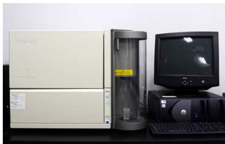
Figure 3.6 : Instrument d'analyse de forme Sysmex FPIA 2100.
