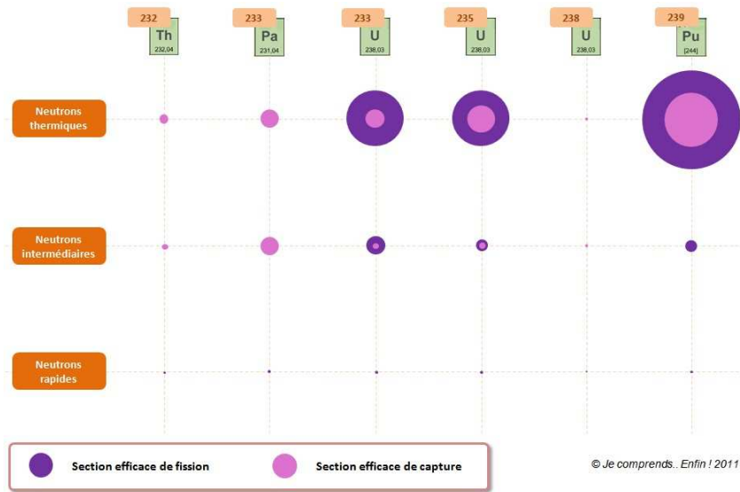
FIG. 1.1 – Représentation visuelle de la section efficace de quelques actinides à différentes énergies du spectre.
