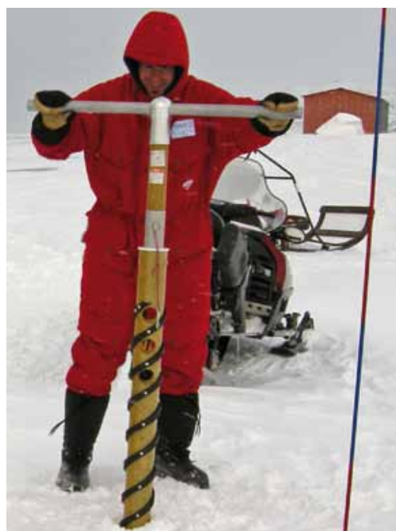
Figure 97 – Le carottier PICO prêt à l'utilisation et testé dans une congère à la base Corbel. Les résultats ont incité à utiliser la méthode de la pesée intégrale étant donné la difficulté à obtenir systématiquement un cylindre de neige (photo : M. Griselin, avril 2008).
