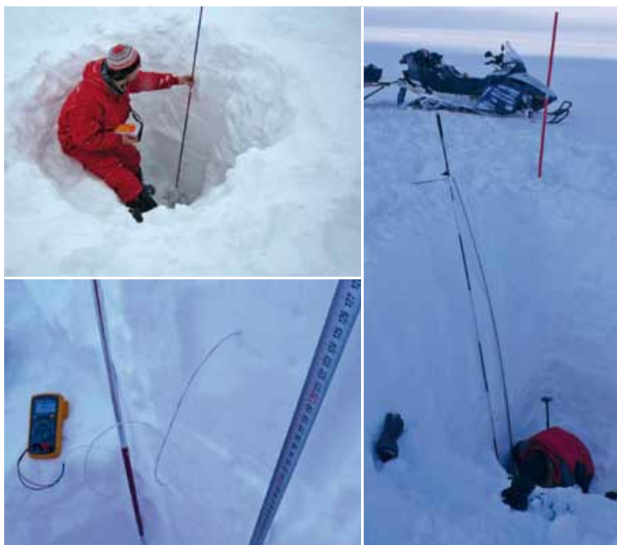
Figure 102 – La réalisation du profil nivologique permet de dresser un portrait du manteau neigeux et d'associer des mesures quantitatives comme la température et la densité. Pour chaque point d'échantillonnage, un puits de neige est ainsi creusé jusqu'à l'interface glace-neige (photos des différentes campagnes d'avril 2008 - M. Griseilin-, 2009 et 2010).
