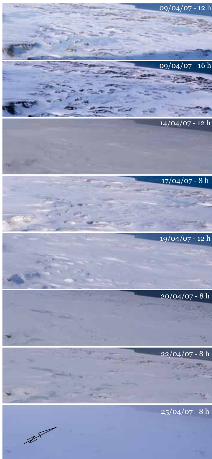
Figure 154 – Suivi de la moraine grâce aux stations photos. D'un point de vue qualitatif et « naturaliste », cette approche permet d'observer la présence d'eau dans le manteau neigeux de la moraine, résultant de la confrontation de la poussée des eaux souterraines aux conditions météorologiques. Au gré des chutes de neige, des coups de gel et de redoux, les zones bleues humides, attestant de la présence d'eau, apparaissent et disparaissent.
