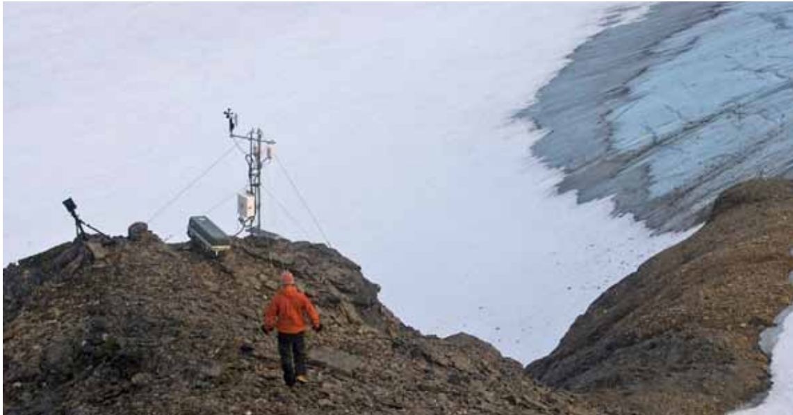
Figure 87 – La station météorologique de l'Épaulement, a été implantée par l'IPEV (Institut polaire) dans le cadre du programme HSF. Bien que les informations soient précieuses, elles sont en revanche très peu représentatives à cause de l'influence de l'effet de col (photo : Ch. Morel, automne 2008 pour le projet «Our Polar Heritage»).
