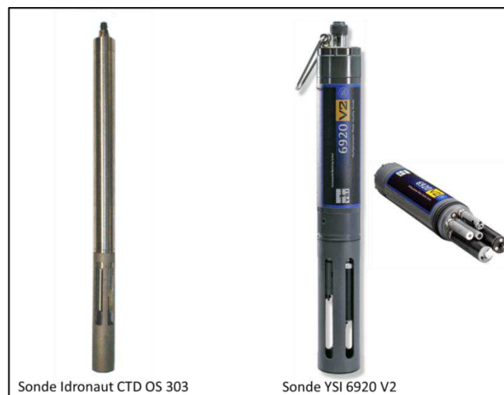
Figure 23 : Aperçu des sondes multi-paramètres employées
