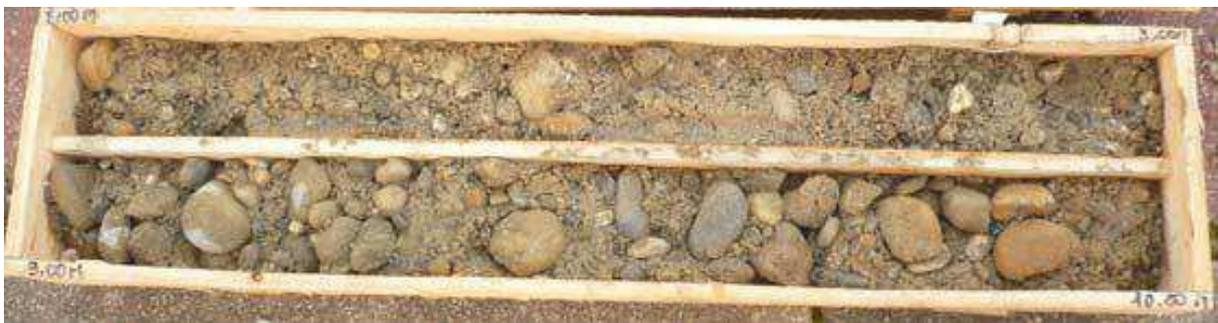
Figure 71 : Carotte de sédiment prélevée sur le piézomètre SP1, entre 8,5 et 10 m de profondeur
