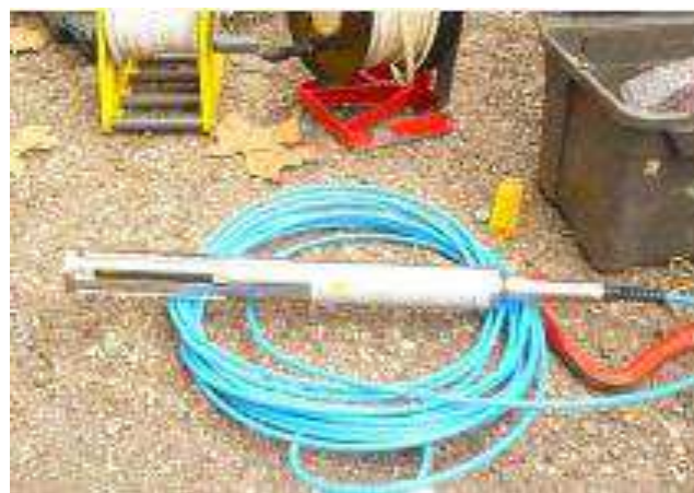
Figure 70 : Sonde multiparamètres installée dans chaque ouvrage sur le site expérimental
