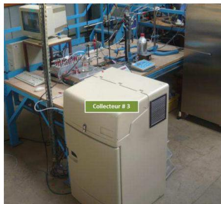
Figure 20 : Collecteur de fraction réfrigéré
