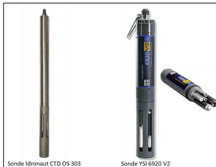
Figure 23 : Aperçu des sondes multi-paramètres employées
