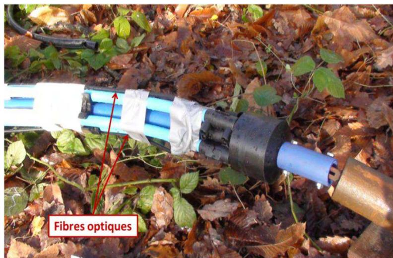
Figure 111 : Vue du pied de la sonde géothermique coaxiale (5 tubes) équipée de sa fibre optique de mesure de température
