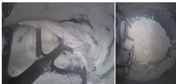
*Figure 5-3. Mise en suspension possible (à gauche). Mise en suspension impossible : fraction volumique maximale atteinte (à droite).*
