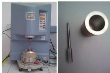
Figure 2-17. Photographie du rhéomètre Bohlin Gemini<sup>®</sup> et de la géométrie vane.
