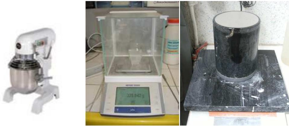
Figure 2-9. Malaxeur Kenwood. Balance de précision utilisée pour peser les additifs et balance utilisée pour mesurer la masse volumique d'une suspension de Kerysten<sup>®</sup> (de gauche à droite).
