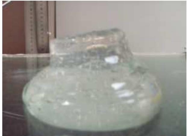
Figure 6-1. Photographies des galettes de dispersions de Carbopol® suite aux essais d'étalement. Seuils évalués en rhéométrie plan-plan rugueuse avec le modèle d'Herschel-Bulkley : a) 21 Pa; b) 28 Pa; c) 62 Pa; d) 100 Pa.
