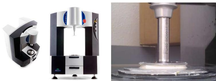
Figure 2-15. Photographie du rhéomètre Kinexus<sup>®</sup> de Malvern Instruments et géométrie plan-plan PU40 mm.
