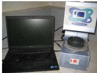
Figure 2-21. Dispositif de Vicat équipé de l'acquisition par ordinateur.
