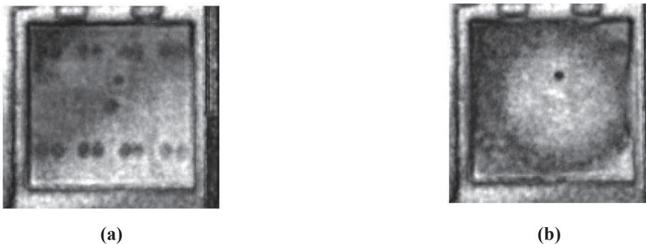
**Figure 1.37** Image de non dégradation (a) et dégradation (b) de la couche de brasure sans plomb entre la puce et le substrat métallisé après 600000 cycles de puissance,  $T_{max} = 125^{\circ}\text{C}$ ,  $\Delta T = 80\text{ K}$ , [HERRMANN\_07]
