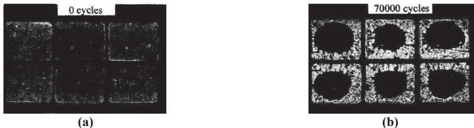
**Figure 1.35** Image MEB de la brasure entre le substrat DCB et la semelle, avant **(a)** et après **(b)** les cycles de vieillissement [MITIC\_99]
