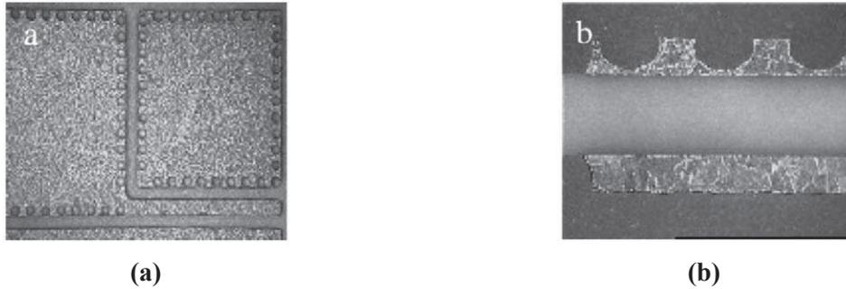
**Figure 1.34** Substrat DCB avec « dimples », vue de dessus **(a)**, coupe **(b)** [SCHULZ\_02]
